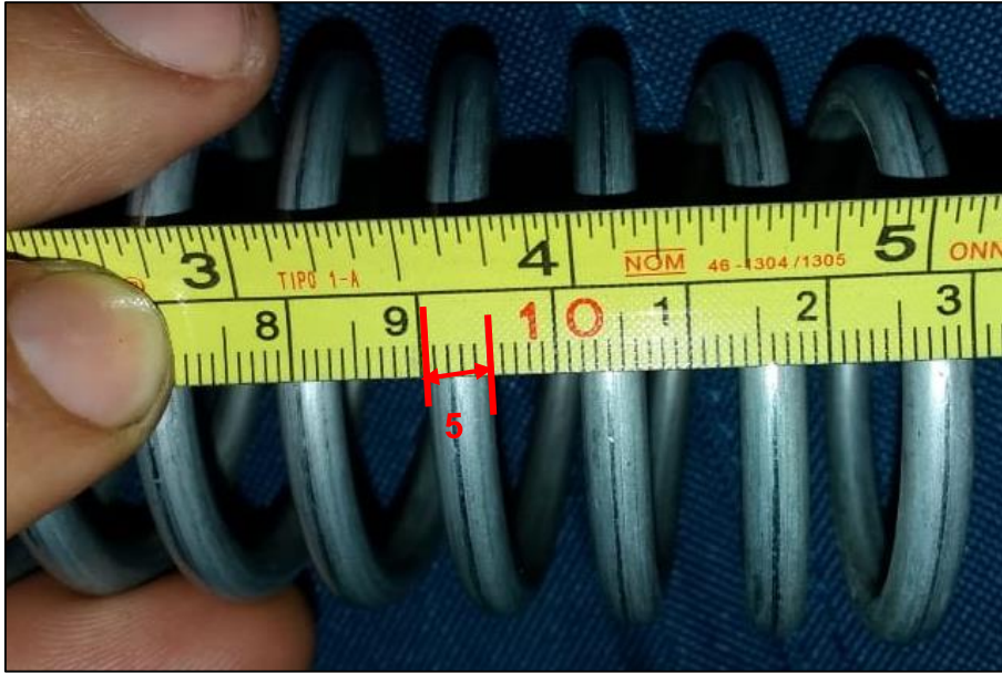
Figura 85: Diámetro del alambre (5 mm)
