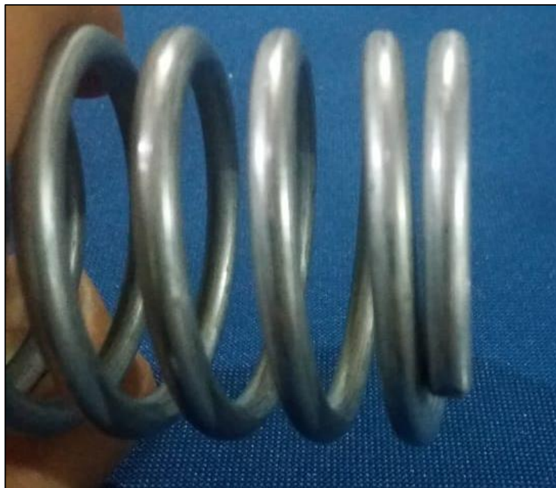
Figura 88: Extremo del resorte escuadrado no rectificad
