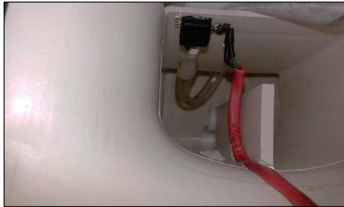
Figura 99: Ubicación del sensor de ingreso de aire en el maniquí
