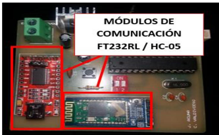
Figura 105: Ubicación de los módulos de comunicación en la tarjeta
