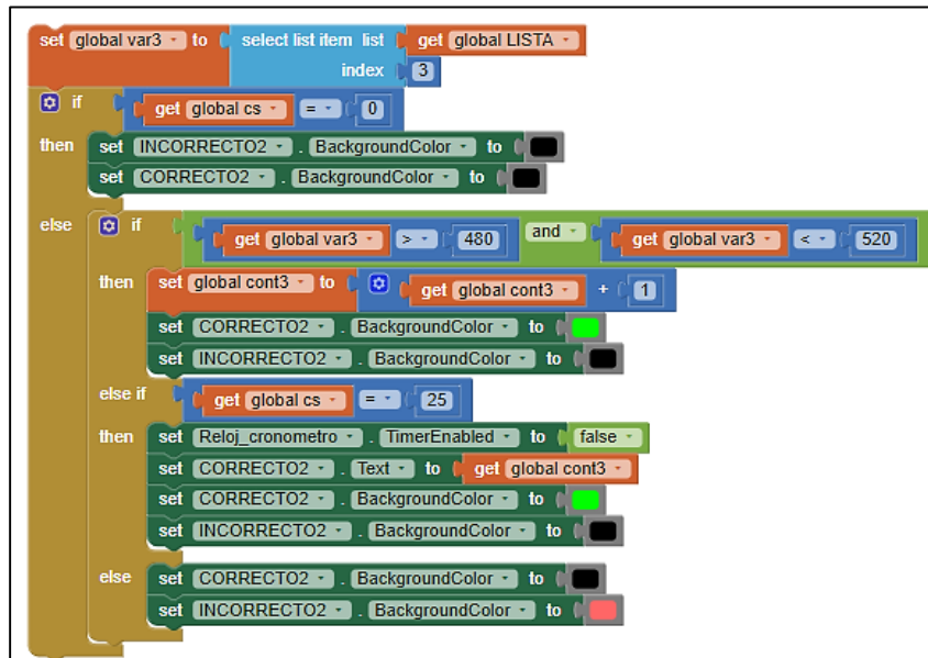
Figura 81: Programación en bloque–Sensor MPXV5100DP
