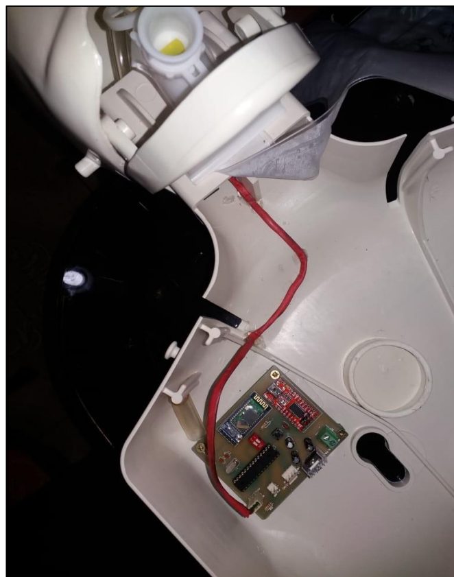
Figura 100: Conexión del sensor MPXV5100DP en la tarjeta
