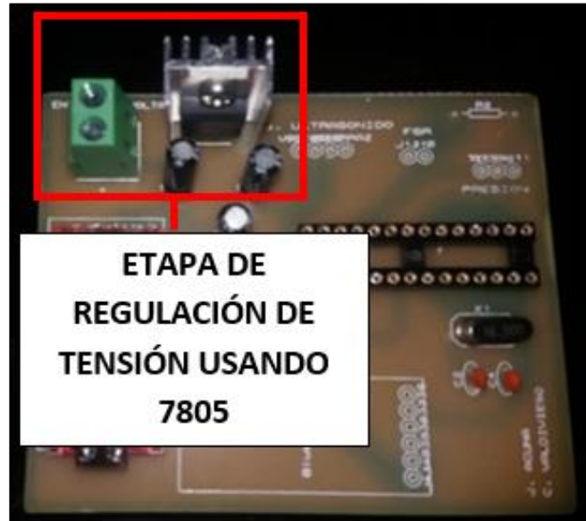
Figura 107: Ubicación de la etapa de regulación en la tarjeta
