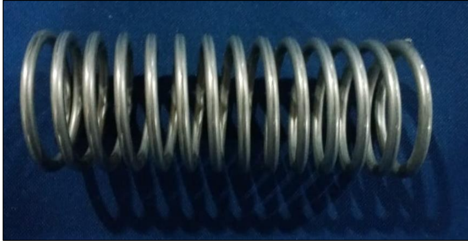
Figura 83: Resorte helicoidal cilíndrico de compresión manufacturado
