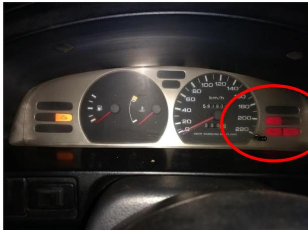
Figura N° 80 Testigo de tablero para encendido.
