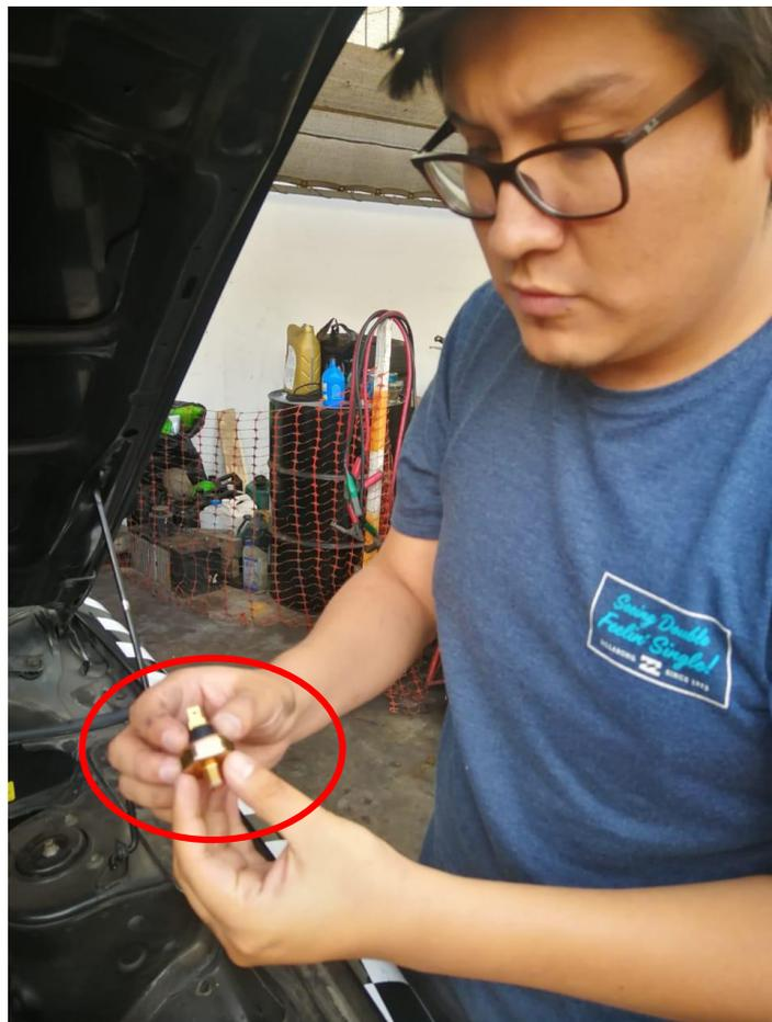
Figura N° 78 Ubicación de sensor de presión de aceite.
