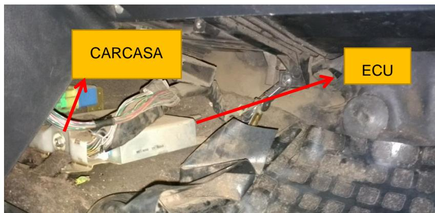
Figura N° 75 Recorrido de cableado de la ECU hacia la carcasa.
