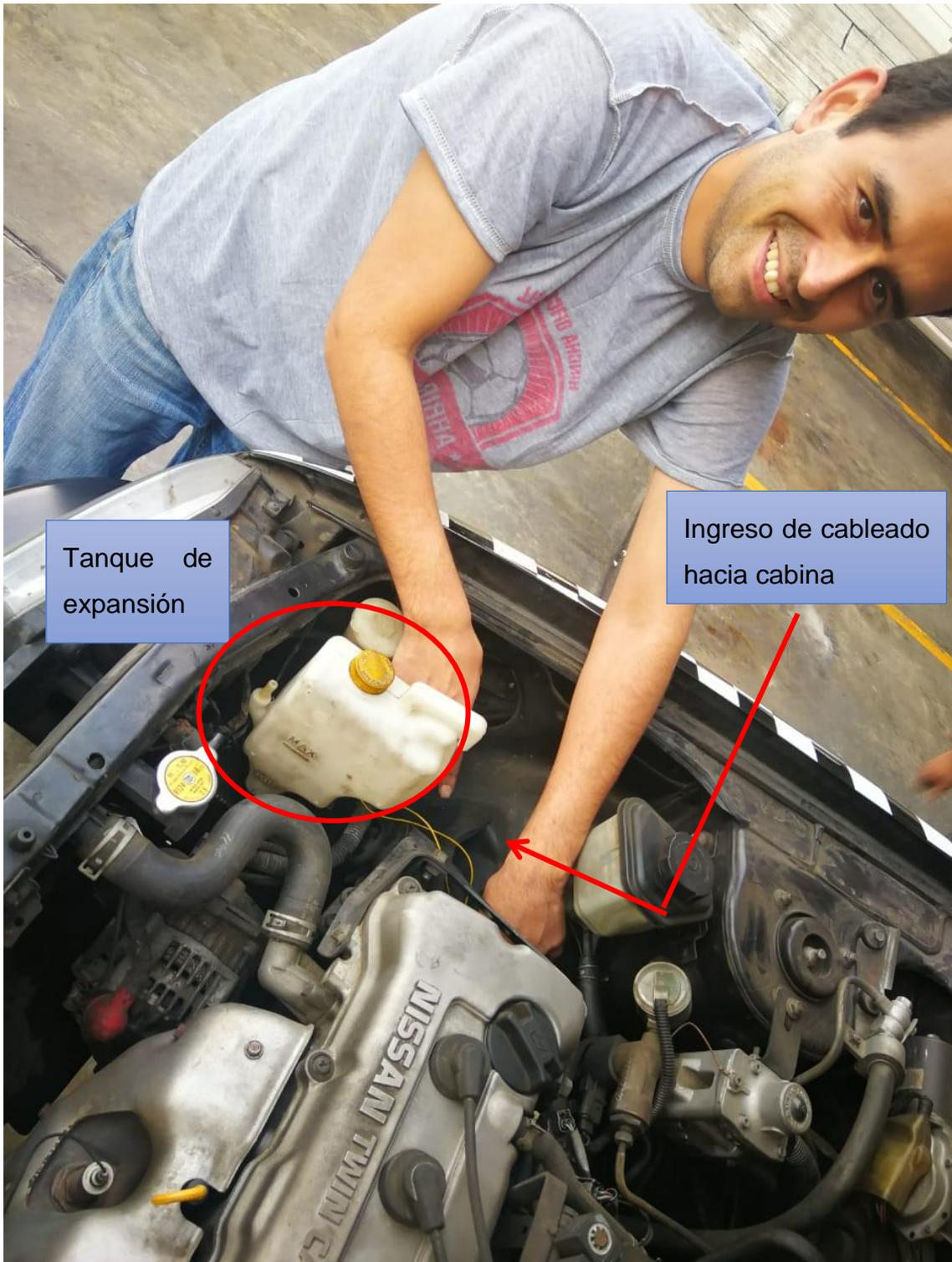
Figura N° 77 Recorrido de cableado de tanque de expansión.
