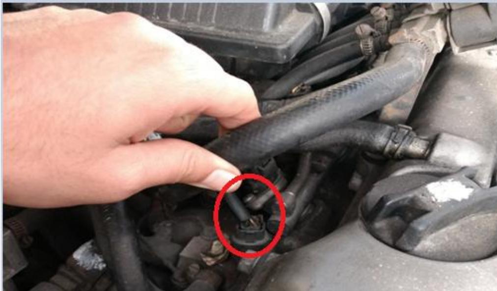
Figura N° 74 Ubicación del sensor de temperatura.
