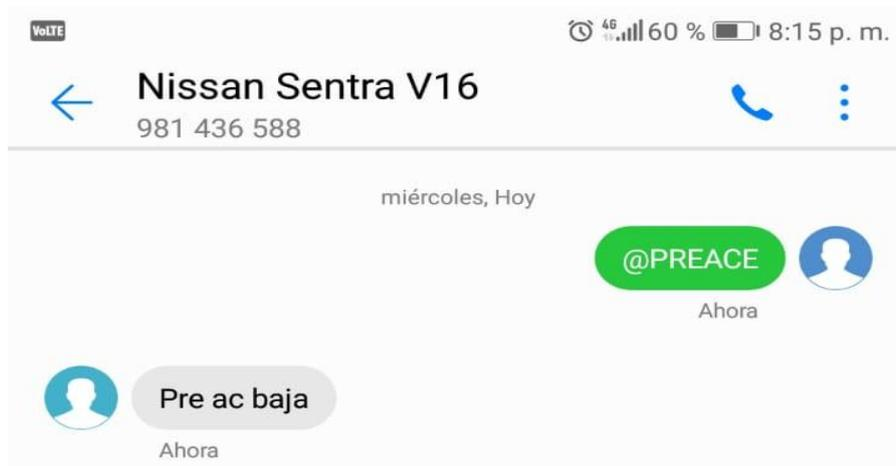
Figura N°94 Mensaje de texto de la presión de aceite de motor.
