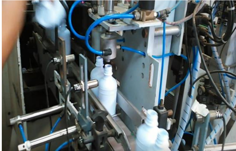
Figura 64. Sistema de retencion activado
