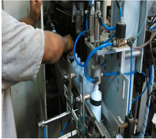
Figura 68. Soplado de envases de plástico
