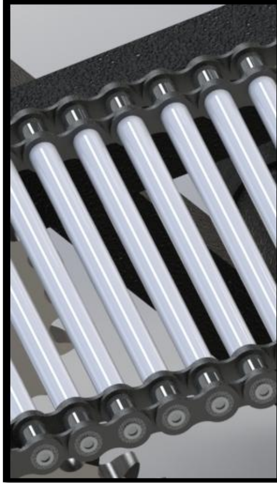
Figura 15: Varillas de acero recubiertas con caucho como faja de oruga
