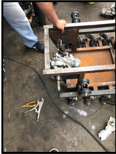
Figura 48: Motores acoplados a la estructura
