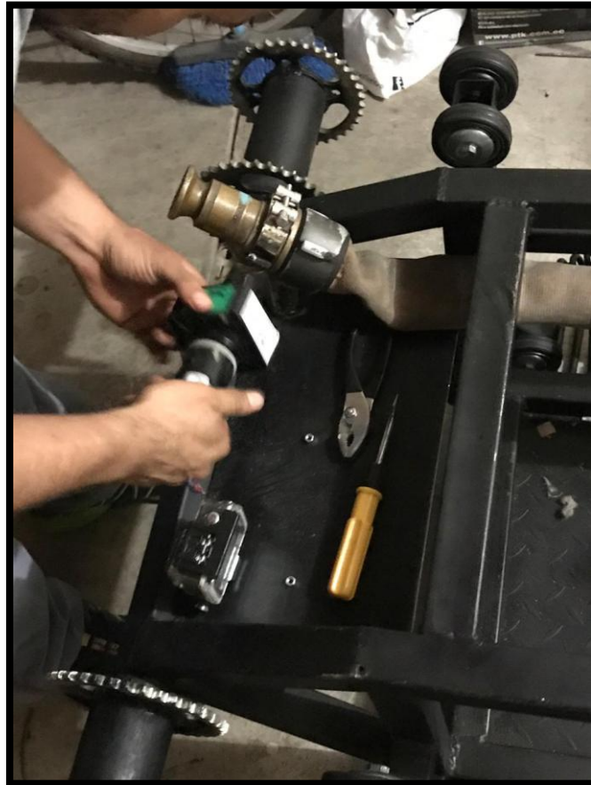
Figura 53: Instalación de boquilla de disparo, motor paso a paso y cámara
