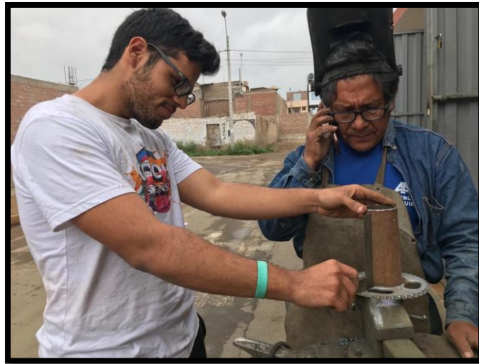
Figura 44: Centrado de carrete de catalinas
