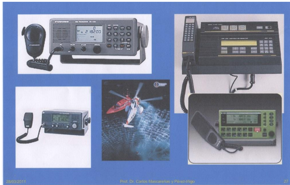
Figura 30: Equipos de Zona A2 - B (MF)
