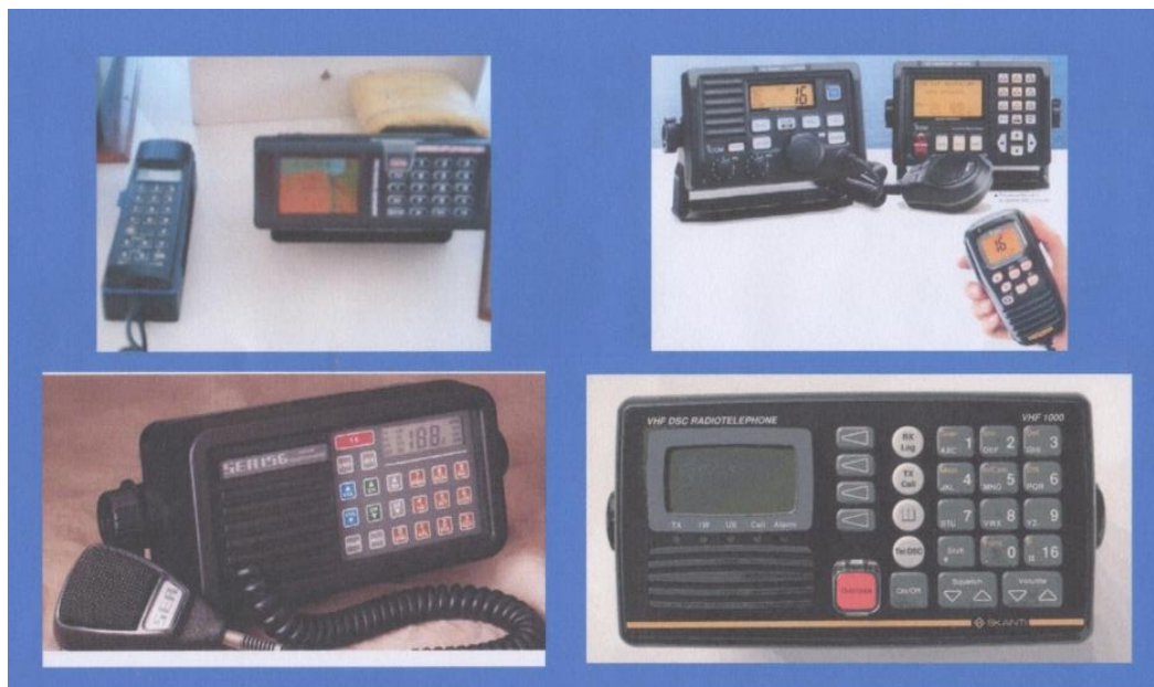
Figura 27: Equipos de Zona A1 - B (UHF)
