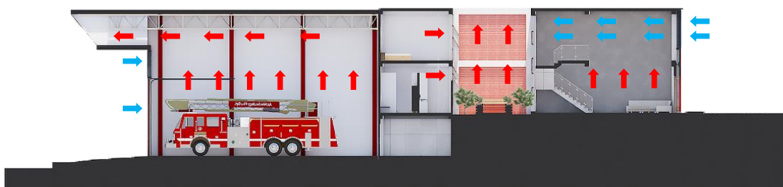
FIGURA 28: CORTE LONGITUDINAL (FLUJO DE AIRE) Fuente: Elaboración Propia
