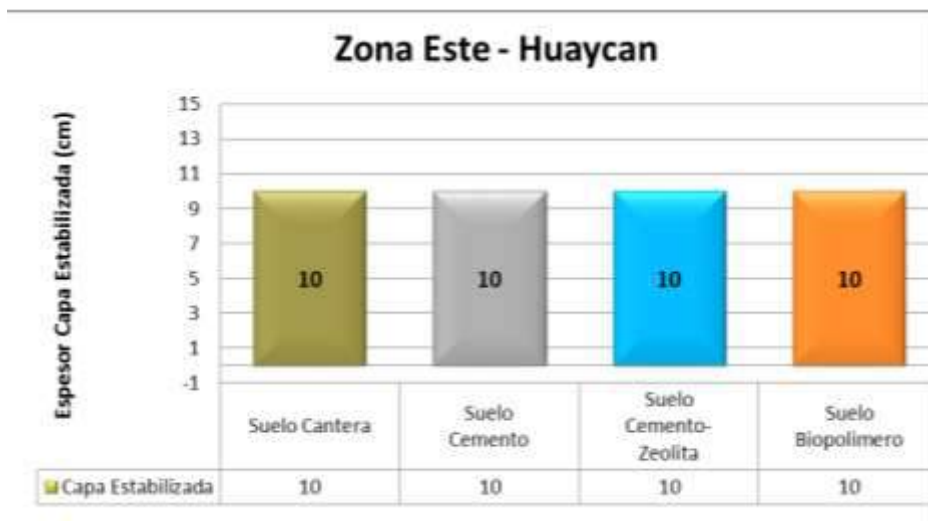
Gráfico 8- 10: Espesores de la Capa Estabilizada (METODO NAASRA) – Este
