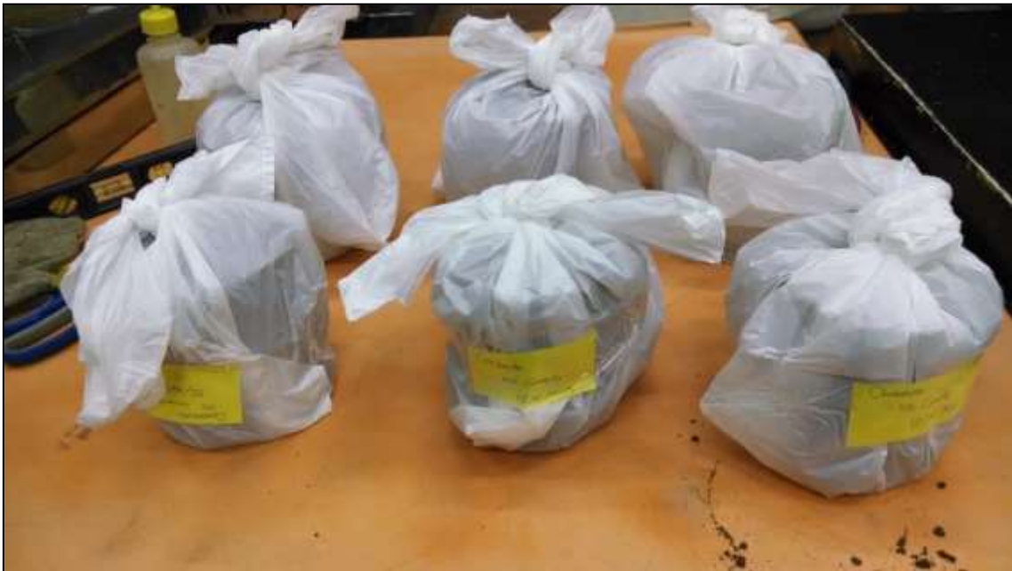
Foto 09: Curado adiabático de las probetas suelo cemento – zeolita.
