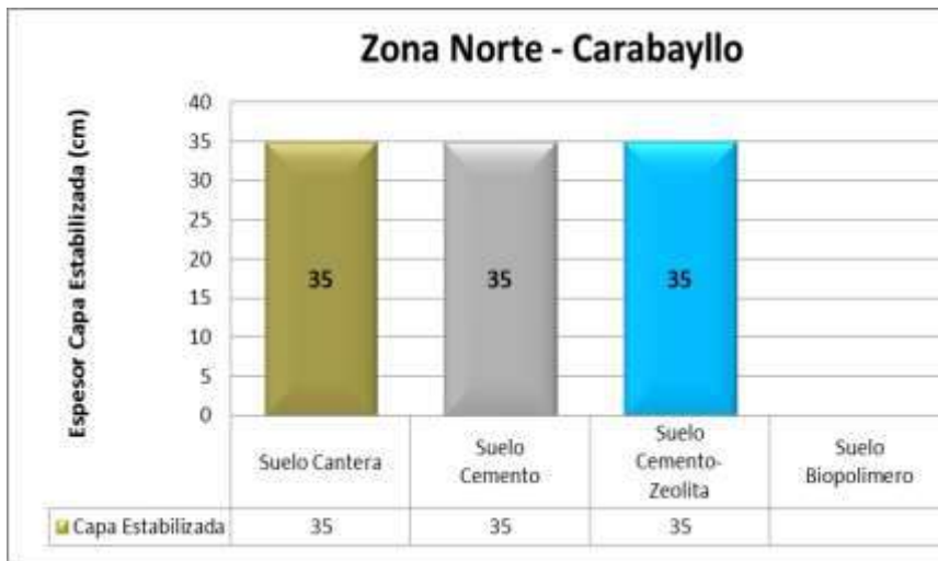
Gráfico 8- 9: Espesores de la Capa Estabilizada (METODO NAASRA)- Norte
