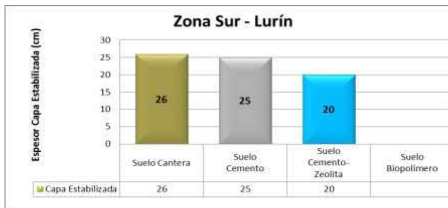
Gráfico 8- 8: Espesores de la Capa Estabilizada (METODO AASTHO) - Sur
