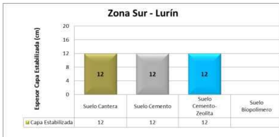
Gráfico 8- 11: Espesores de la Capa Estabilizada (METODO NAASRA) – Sur
