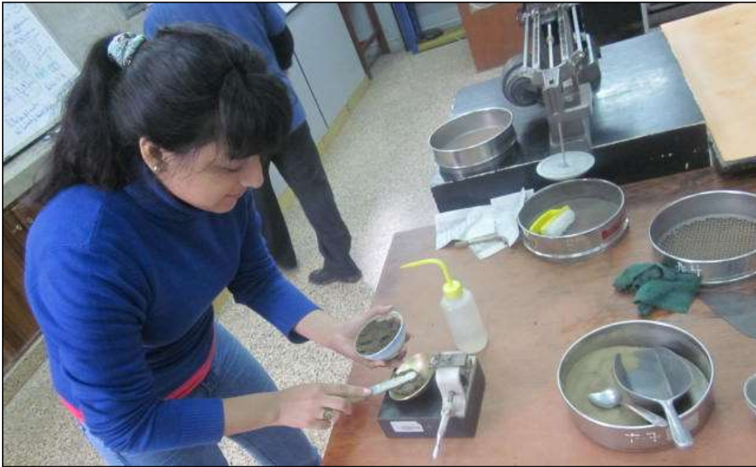
Foto 01: Realizando el ensayo de límite líquido.
