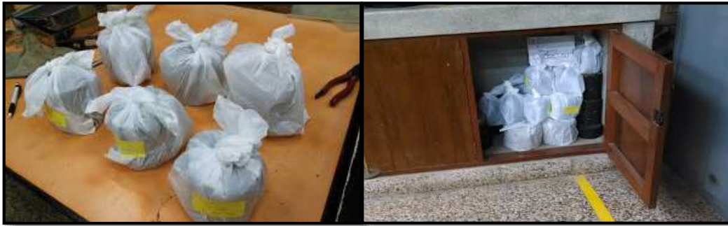
Figura 7-14: Curado hermético de probetas
