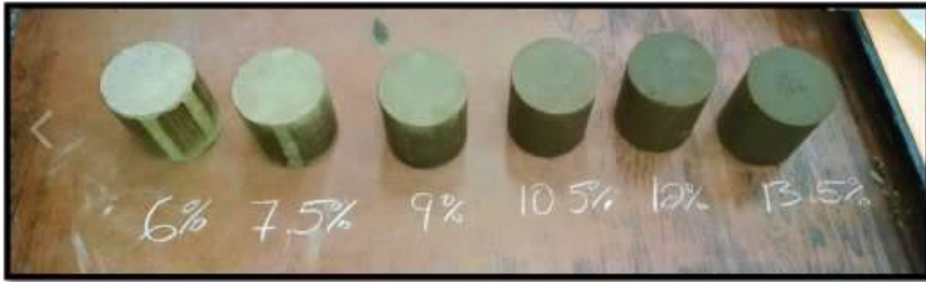
Figura 7-6: Moldes de la curva Proctor Modificado del suelo de Carabaylo.
