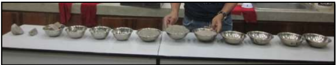
Figura 7-5: Material retenido del ensayo de granulometría.
