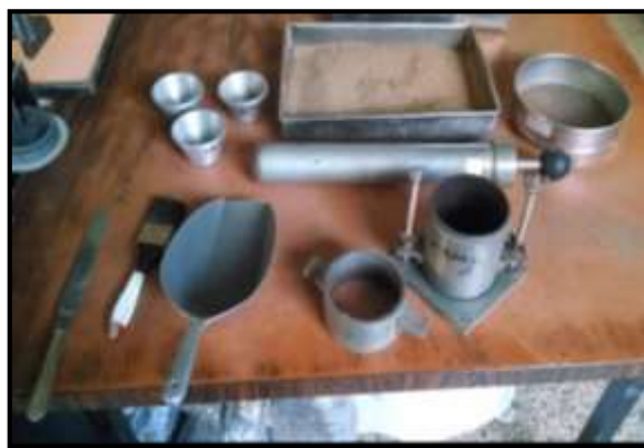
Figura 7-10: Instrumentos para el ensayo compresión simple. Laboratorio de Mecánica de suelos y Pavimentos de la URP.
