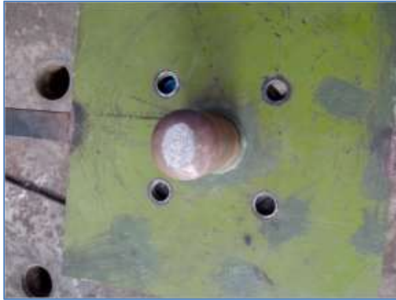
Gráfico 3.11: Desgaste del tubo macizo del sistema FPS
