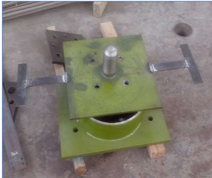
Imagen A1-7: Sistema de aislamiento propuesto del tipo FPS
