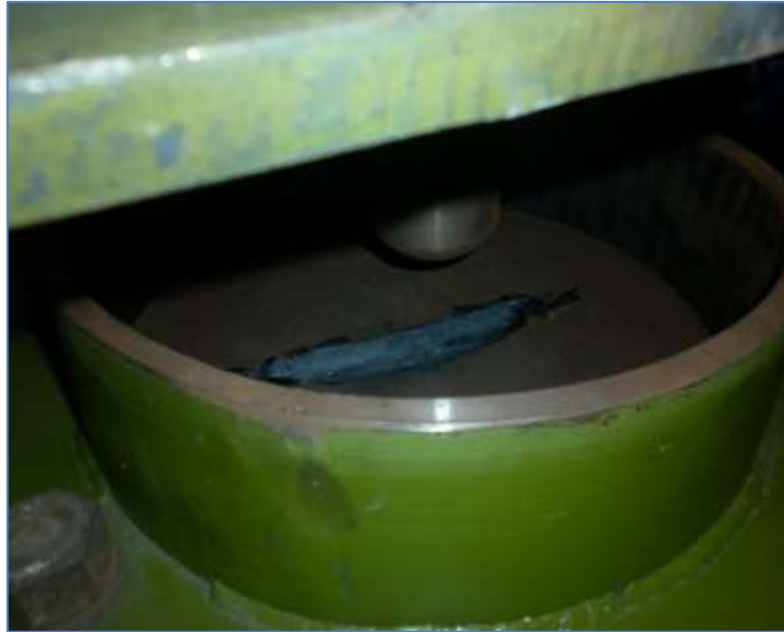
Imagen A1-11: Raspadura o desgaste de la superficie después del ensayo
