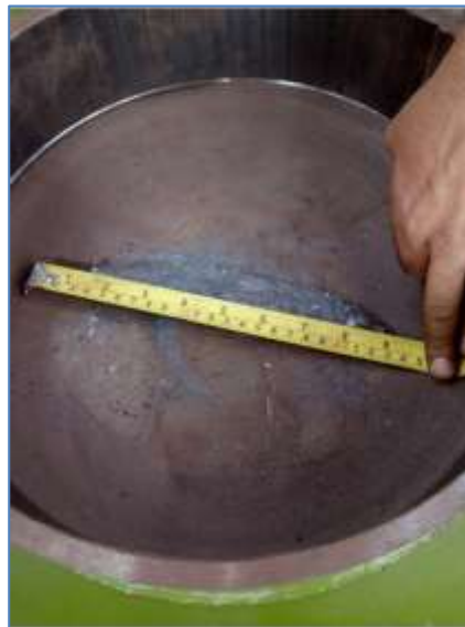
Gráfico 3.10: Superficie raspada del sistema – longitud (23 cm apróx)
