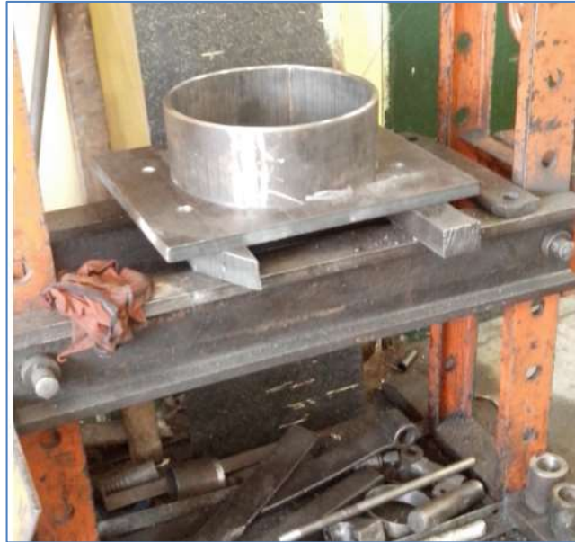
Imagen A1-4: Colocación y previa soldadura a plancha de tope
