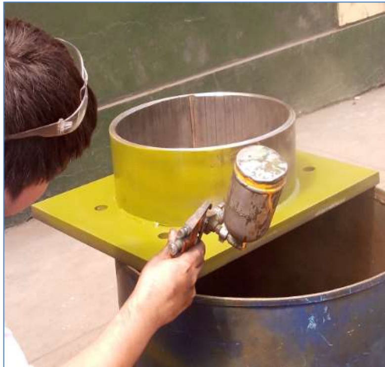
Imagen A1-5: Colocación de pintura al sistema de aislamiento
