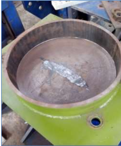
Imagen 3.9: Superficie raspada del sistema después de los ensayos cíclicos
