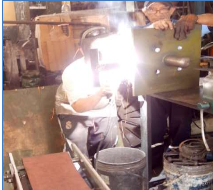
Imagen A1-6: Soldadura de los aleros a la plancha superior
