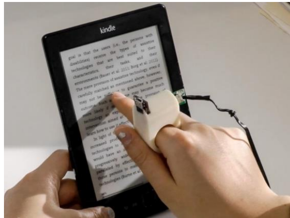
Imagen 14: Finger Reader. Lectora automática
