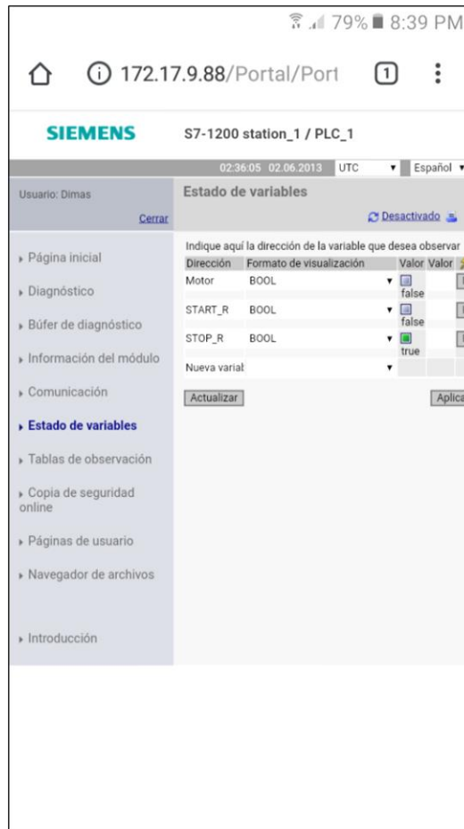
Figura N° 37: Interacción de las variables del PLC desde un dispositivo móvil.
