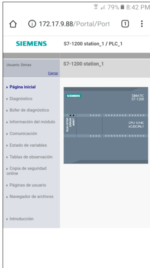
Figura N° 36: Verificación del estado del PLC desde un dispositivo móvil.
