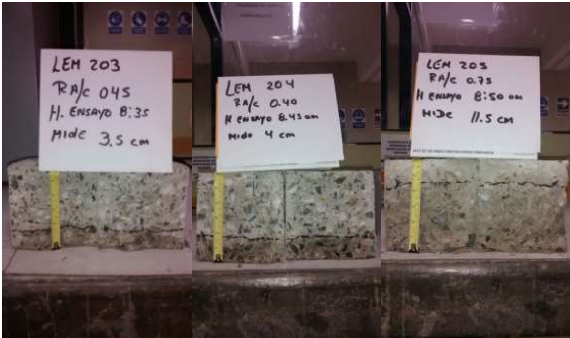
Figura 18, 19 y 20. Ensayos de permeabilidad Fuente y elaboración: Propia
