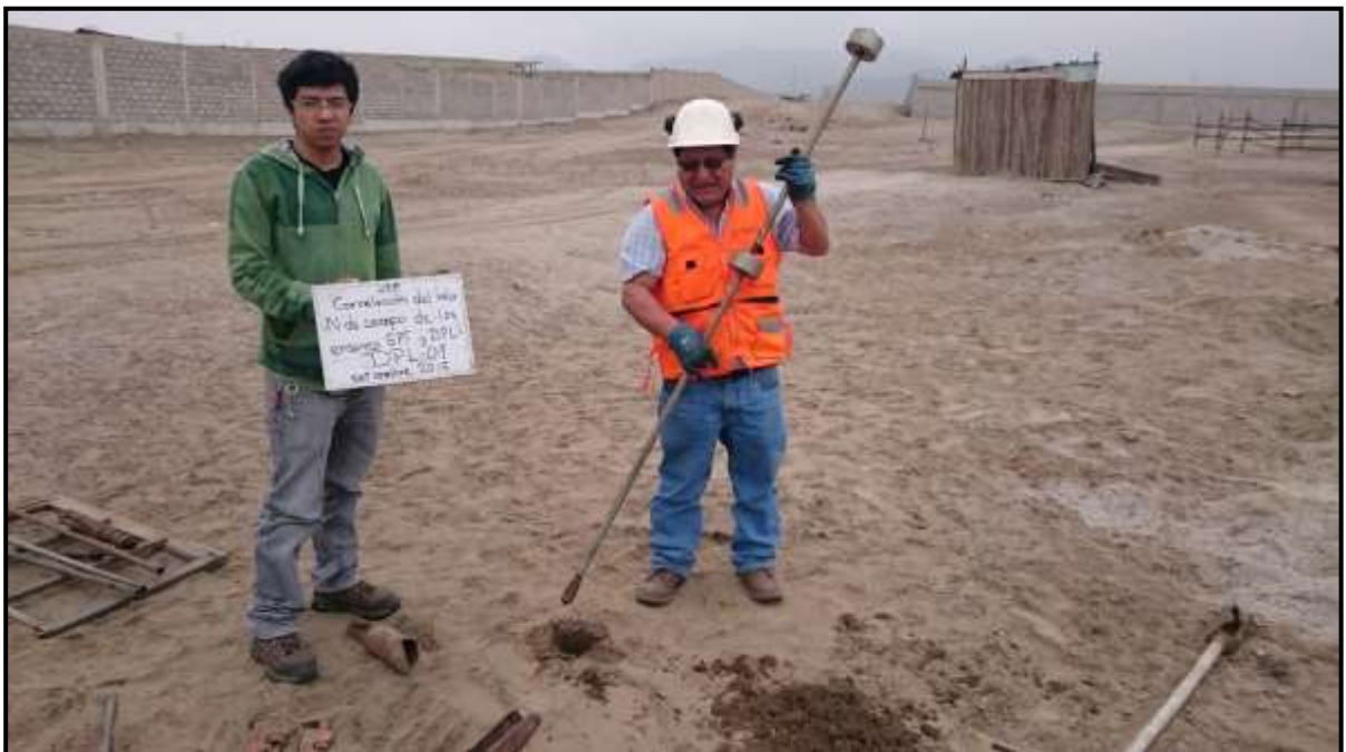
Figura 25. Vista del ensayo DPL - 01, ubicado en la zona nor-oeste de la zona en estudio; se puede apreciar la punta cónica de la varilla de penetración, y también el tope y la contra masa donde se impulsará el martillo.
