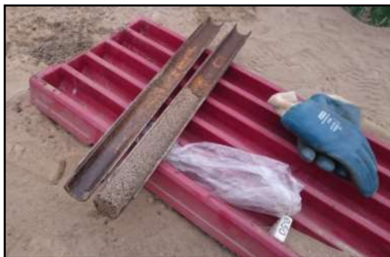
Figura 17. Vista del material recuperado con la tubería de caña partida (0.50m-0.95m), donde se observa claramente el material arenoso recuperado de la zona.
