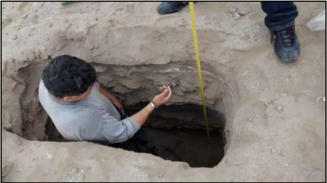
Figura 44. Vista del perfil estratigráfico de la calicata C-01, se observan los dos estratos definidos, y el lente de caliche a 0.20m. de profundidad.
