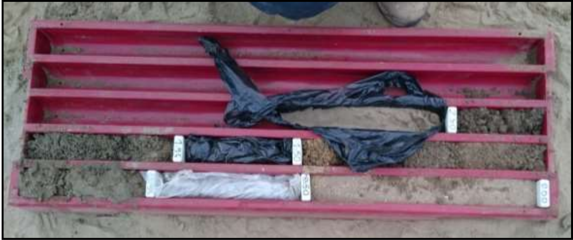
Figura 14. Vista de las muestras recuperadas en el ensayo SPT, con la posteadora manual, y con el tubo muestreador de caña partida.
