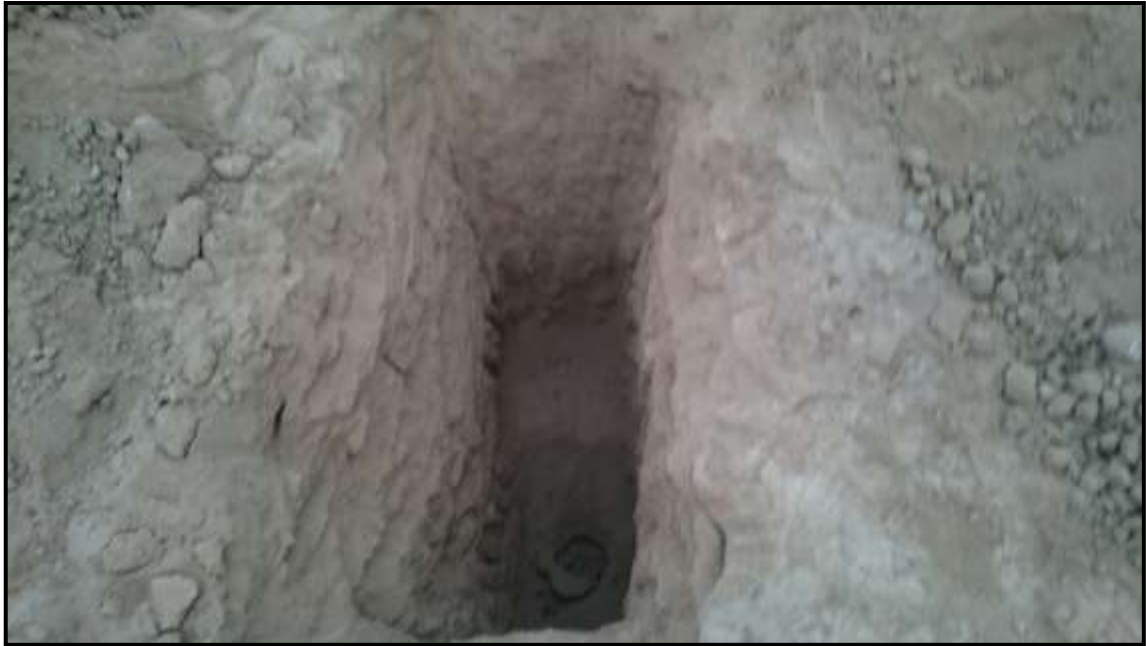
Figura 47. Vista del perfil estratigráfico de la calicata C-02, se observa que los dos estratos encontrados, son bastante similares.
