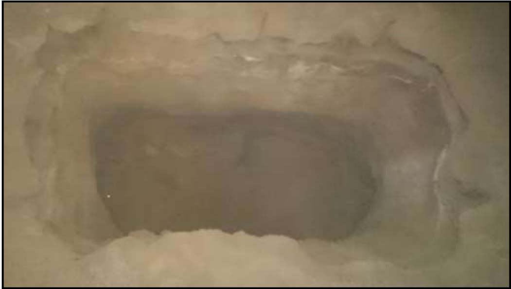
Figura 50. Vista del perfil estratigráfico de la calicata C-03, se observa que los dos estratos encontrados, son bastante similares, también se puede distinguir el lente de caliche encontrado.
