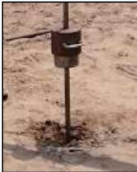
Figura 24. Vista del martillo de 10 Kg., el tubo guía y la varilla de penetración.
