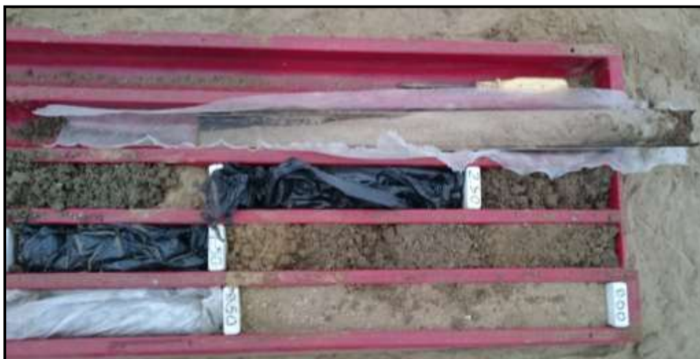
Figura 21. Vista de todas las muestras obtenidas durante la ejecución del ensayo SPT 02, en general, se puede observar un material arenoso, aparentemente homogéneo.
