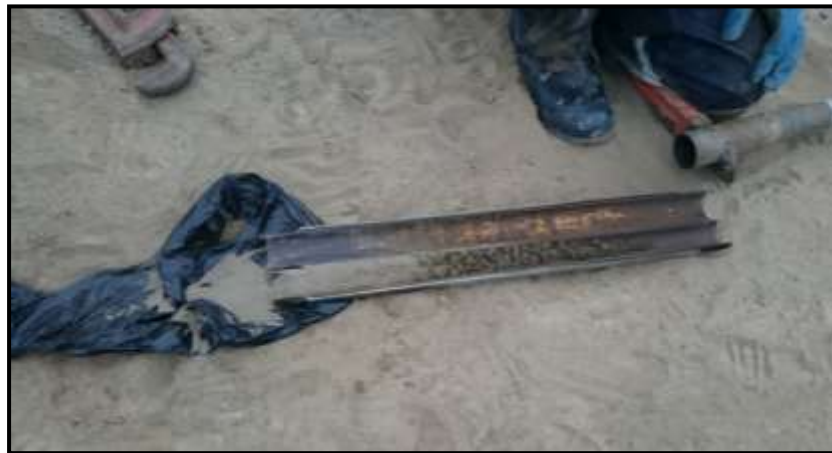
Figura 20. Vista de la muestra obtenida a la profundidad de 0.50m, se observa un material arenoso de color gris.
