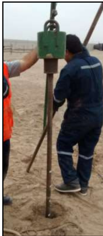
Figura 13. Vista del equipo SPT, donde se aprecia el martillo de 140 Lb, de peso y tubería de penetración donde se indican los tramos a medir la resistencia.
