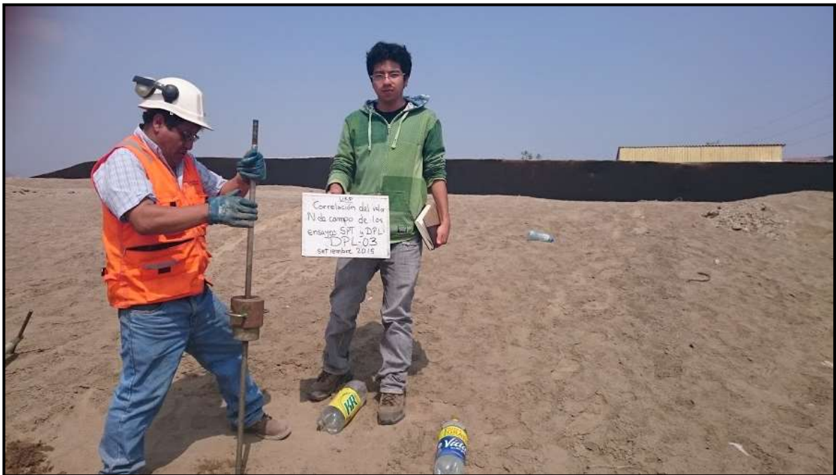
Figura 29. Vista del ensayo DPL - 03, en la imagen se puede observar el equipo de DPL sin la contra masa, se estaba colocando el equipo lo más perpendicular posible, para comenzar con el ensayo.
