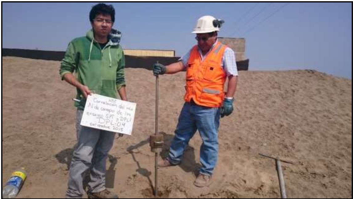
Figura 31. Vista del ensayo DPL - 04, en la imagen se puede observar el equipo de DPL, en el último ensayo, donde se produjo el rechazo, a una profundidad aproximada de 0.90m.
