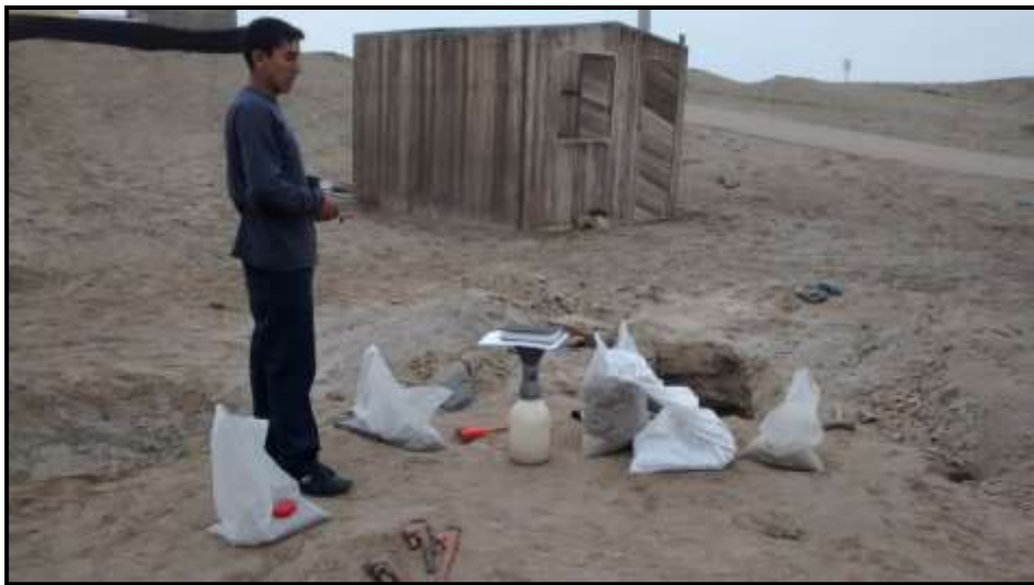
Figura 9. Obtención de muestras de la calicata C-01.
