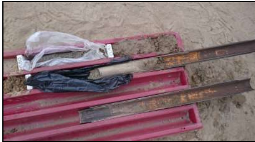
Figura 18. Vista del material recuperado con la tubería de caña partida (1.50m-1.95m), donde se puede ver un material más fino que el anterior.
