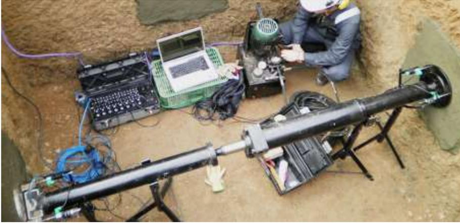
Figura 15. Ensayos Carga de Placa Horizontal
