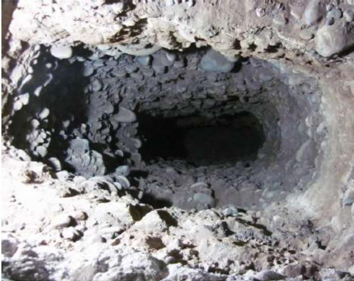
Figura 18. Calicata para ensayos en el Conglomerado de Lima
