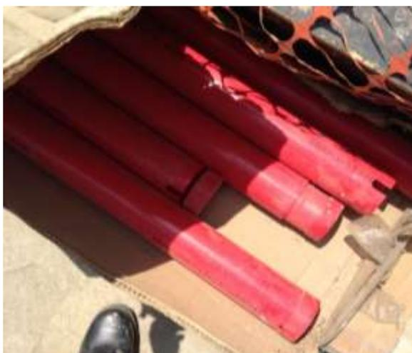
Figura 58. Casing o tubo para las mediciones con inclinómetros.
