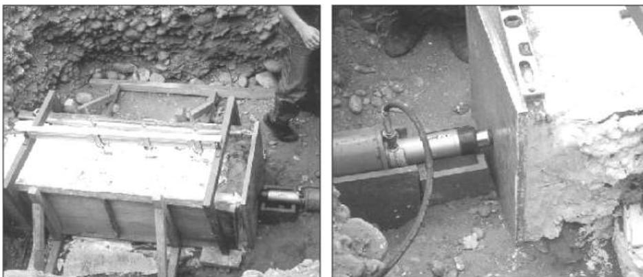
Figura 17. Ensayo de Rotura Progresiva
