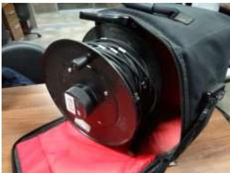
Figura 35. Cable eléctrico de inclinómetro (RST Instruments)
