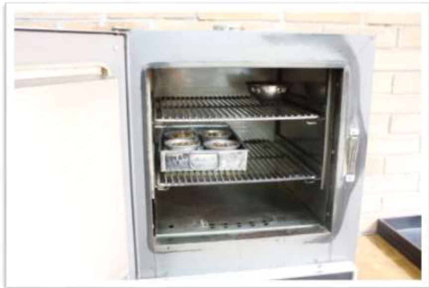
Foto 11: Colocación de los recipientes y del material húmedo al horno.
