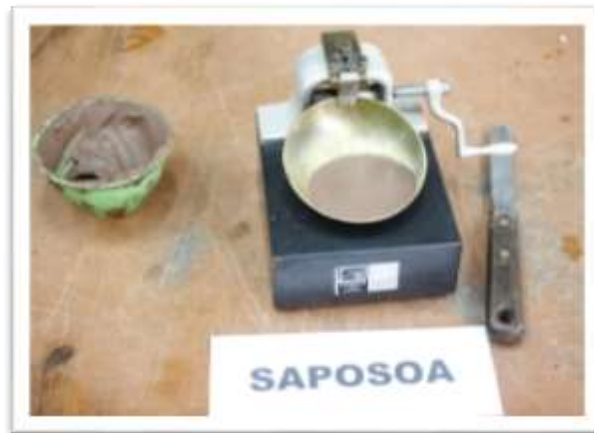
Foto 24: Colocación del material en la cuchara de Casagrande
