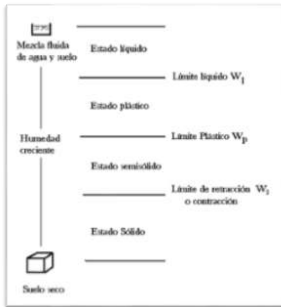
Figura 1 : Diagrama Límites de Consistencia de Atterberg.
