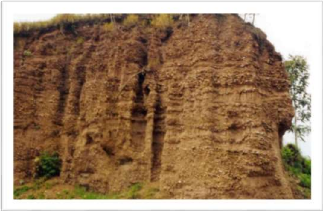
Foto 5: Secuencia de niveles conglomerados, que se exponen en forma masiva. Tramo Saposoa-Sacanche
