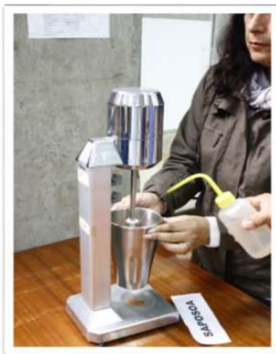
Foto 40: Vaso de dispersión en aparato agitador
