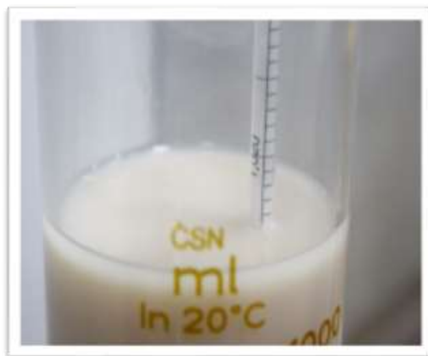
Foto 43: Medida del Hidrómetro
