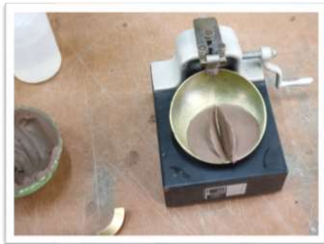
Foto 26: Unión de las dos mitades de la pasta de suelo en la cuchara de Casagrande
