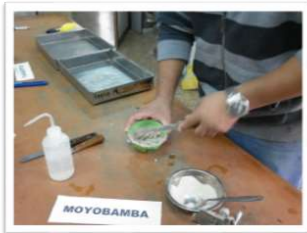
Foto 28: Preparación de la Muestra para Límite Plástico
