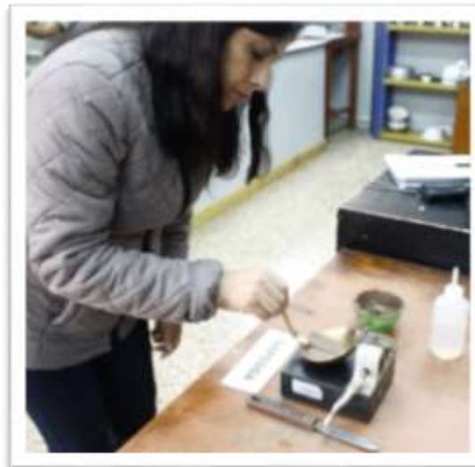
Foto 25: Hendidura hecha con el Acanalador.
