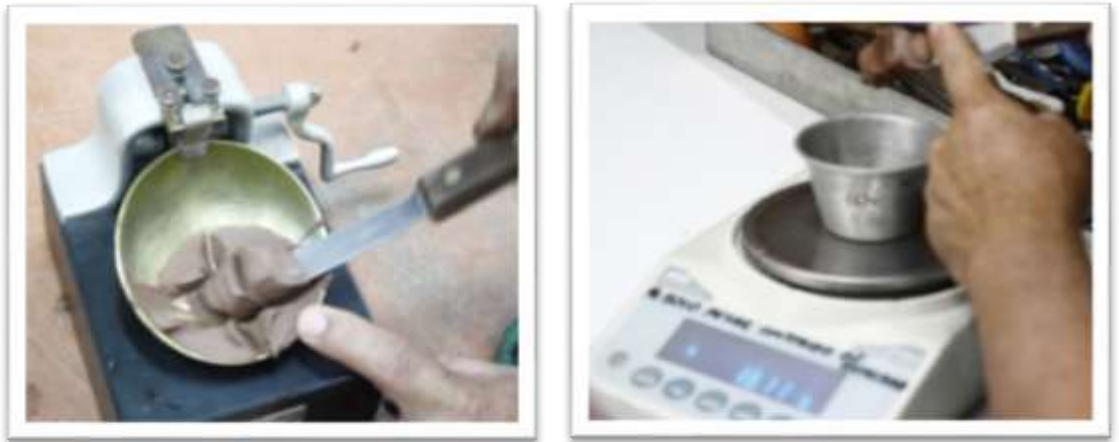
Foto 27: Obtención de la muestra para ser llevado al horno.
