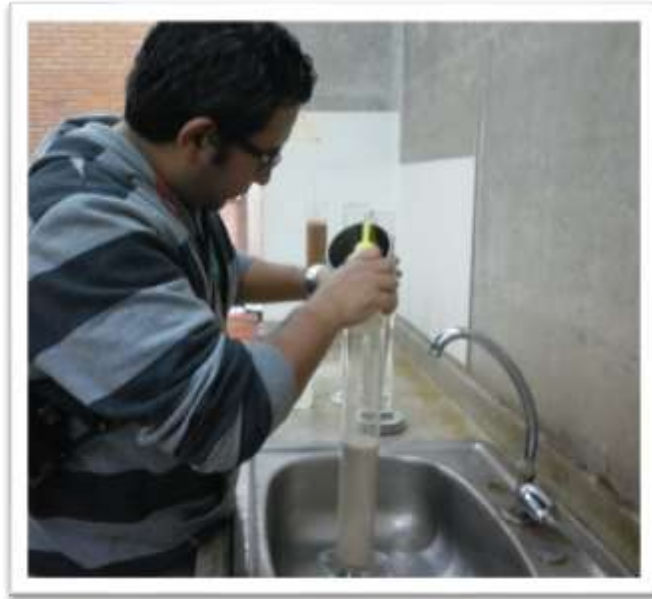
Foto 41: Verter la suspensión a un cilindro
