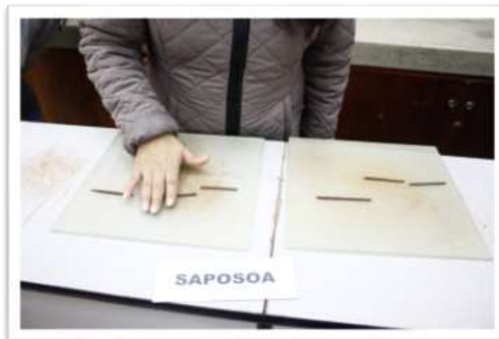
Foto 29: Formación de la Muestra cilíndrica de Límite Plástico
