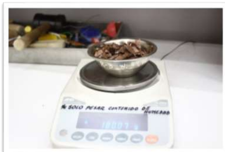
Foto 10: Determinación del peso del recipiente y del material húmedo.
