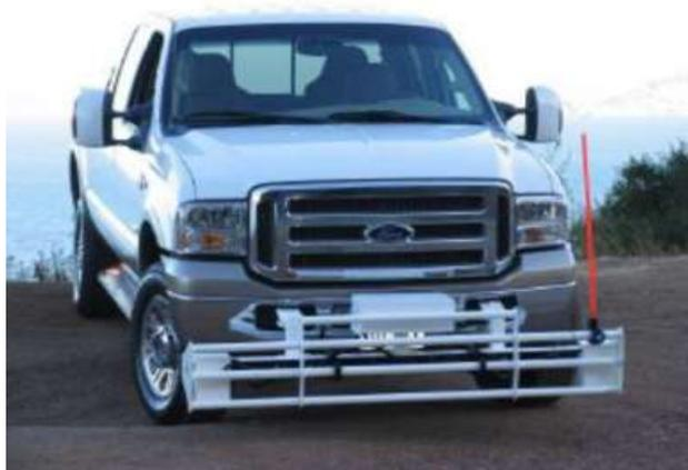
**Figura 2.23 Equipo de Clase I: Perfilómetro Láser de la marca SSI**
