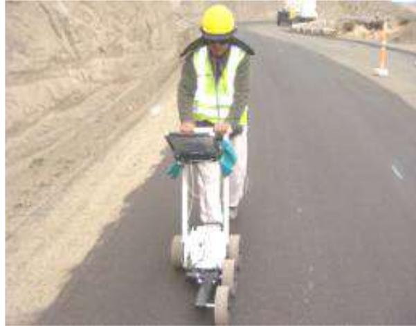
**Figura 2.24 Equipo de clase I: Walking Profiler de la marca SSI**
