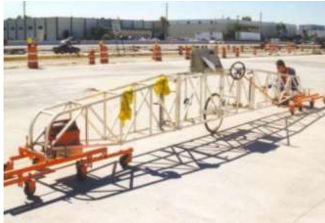
**Figura 2.26 Equipo de clase II: Perfilógrafo California**
