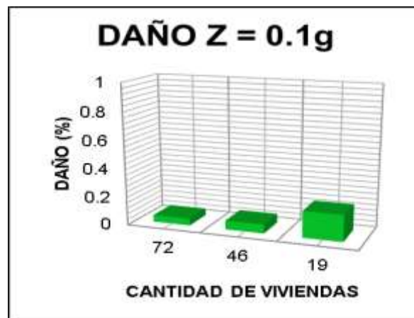
Figura 36. Porcentaje de daño por cantidad de viviendas 0.1g
