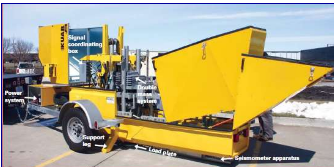
Figura N° 30 Partes del Deflectómetro de Impacto HWD Kuab 240.
