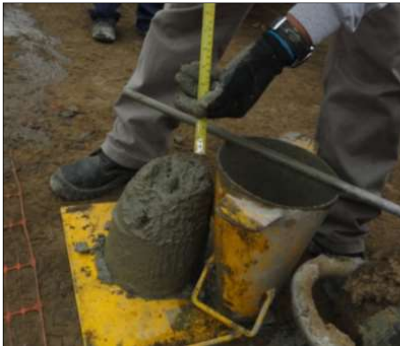
Fotografía N°4: Técnico realizando el ensayo del cono de Abrams, Fuente: Resumen fotográfico de la Obra Alameda en la Av. Santa Rosa en San Juan de Lurigancho tramo Av. Próceres de la independencia – Av. Canto Grande.
