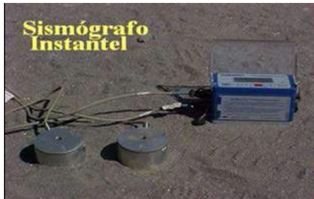
Foto 05 - Equipos de Sismógrafos Instantel
