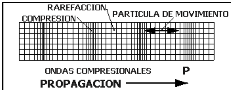
Fig. 04 - Onda Primaria o Longitudinal "P"
