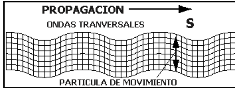
Fig. 05 - Onda Secundaria o Transversal "S"
