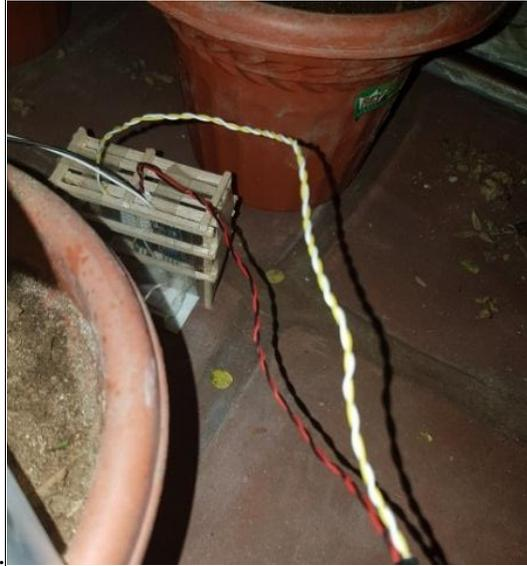
Figura N° 106: Conexión de la implementación del sensor DHT22
