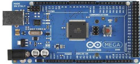
Figura N° 14: Arduino Mega 2560
