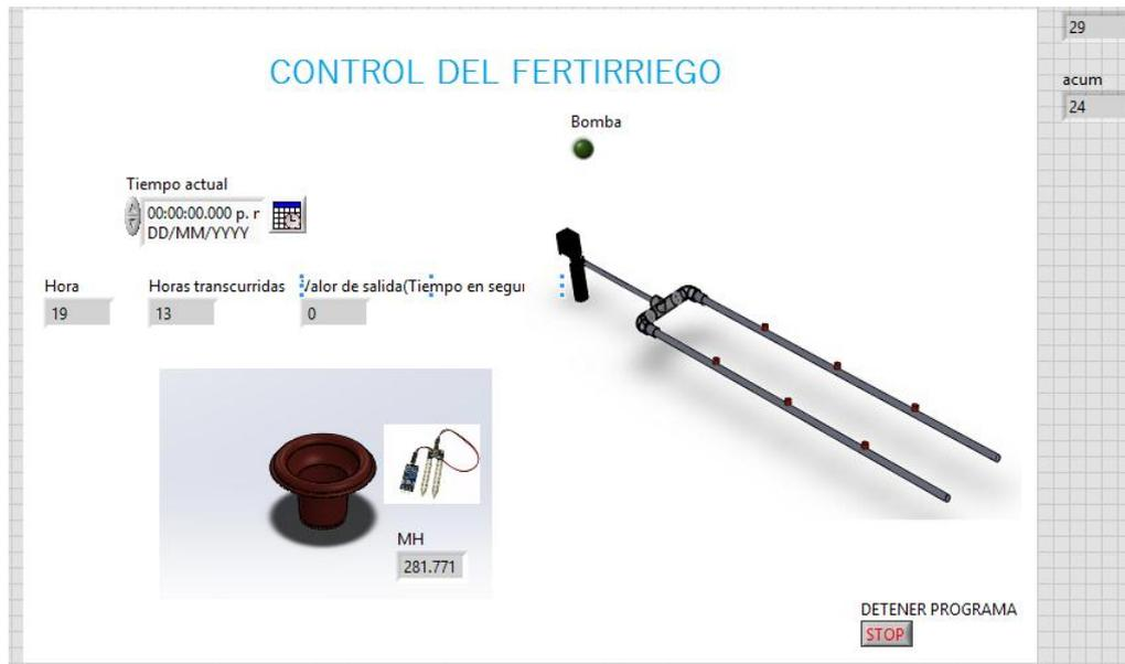
Figura N° 83: Panel frontal del control del fertirriego
