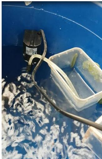
Figura N° 117: Inyector Venturi y bomba en funcionamiento
