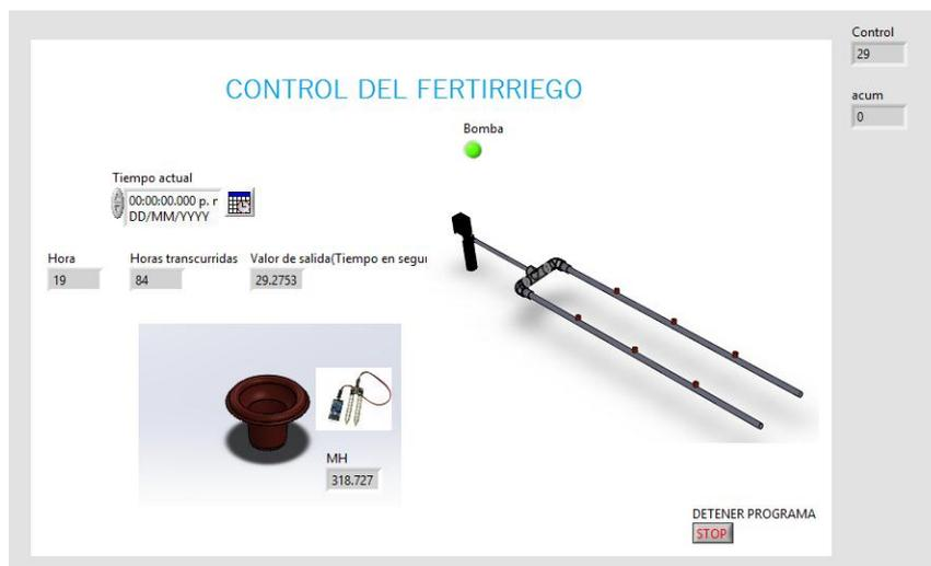
Figura N° 84: Simulación del control difuso del fertirriego
