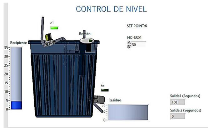
Figura N°63: Simulación del control de nivel
