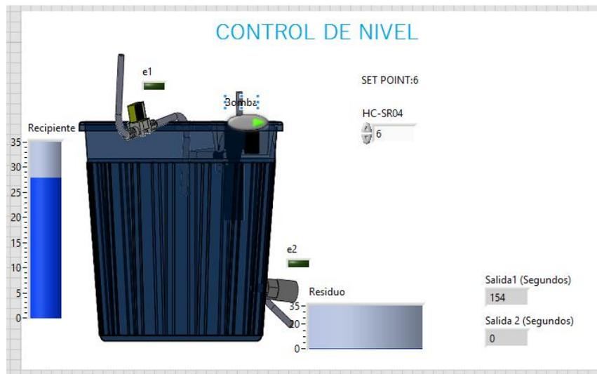
Figura N° 60: Panel frontal del control de nivel
