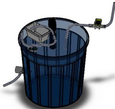
Figura N° 40: Componentes del control del nivel del recipiente
