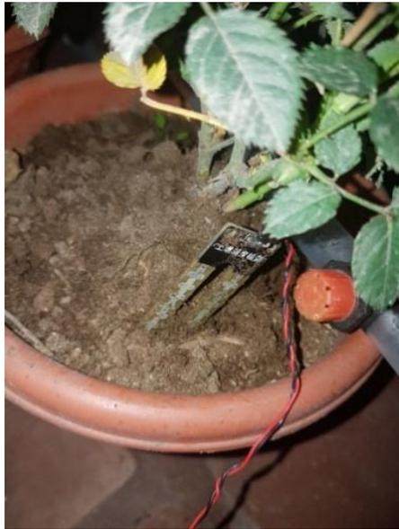
Figura N° 125: Sensor MH colocado en la tierra
