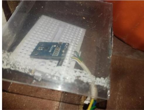
Figura N° 118: Sensor BH1750 colocado
