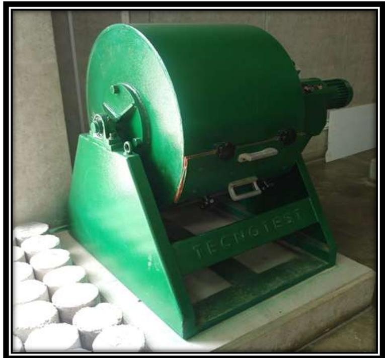
**Figura 17. Máquina de Desgaste de Los Ángeles.** Fuente: Laboratorio de Escuela de Ingeniería Civil, URP
