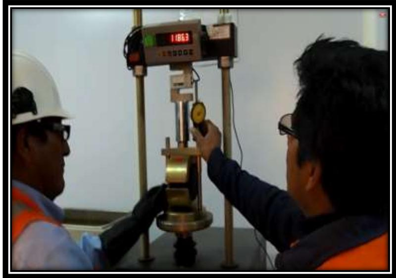
**Figura 23. Medición de la estabilidad Marshall y fluencia.**
