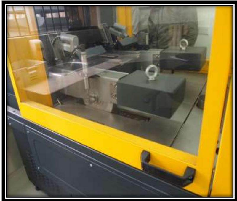
**Figura 24. Máquina de Ensayo Hamburg Wheel-Tracking Device (HWT)**
