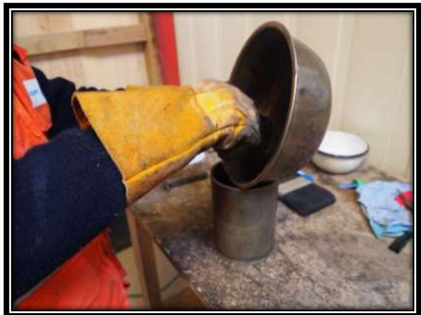
**Figura 20. Colocación de mezcla asfáltica en moldes.**
