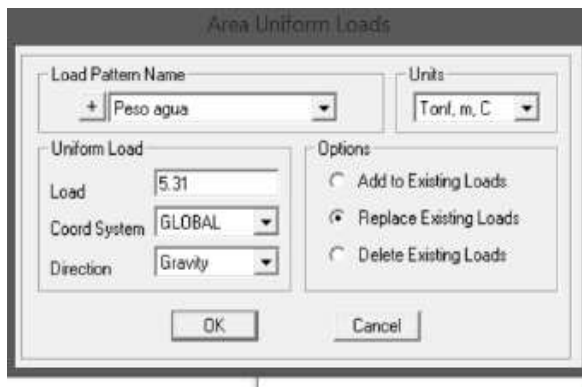
Figura 43. Asignación de la cargas de la losa
