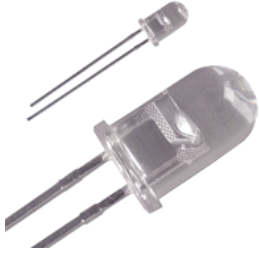
Fig. 3-22: Diodo emisor de luz infrarroja [18]
