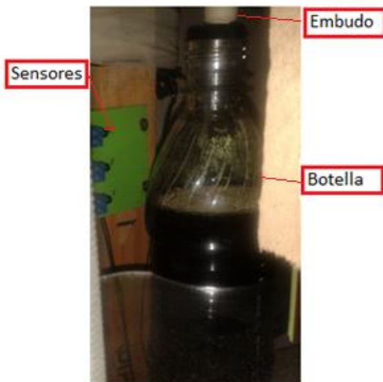
Fig.4-26: Botella con el nivel de llenado por debajo de lo aceptado.
