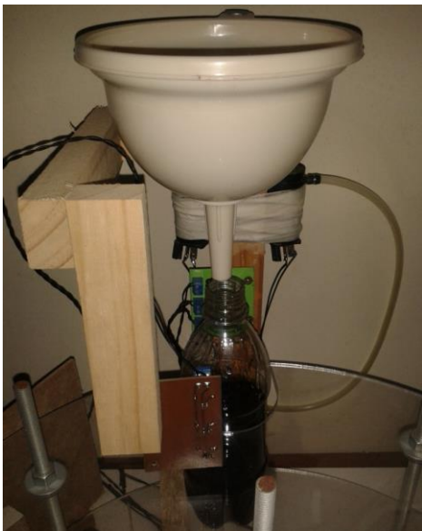
Fig. 3-32: Medición de llenado de la botella.
