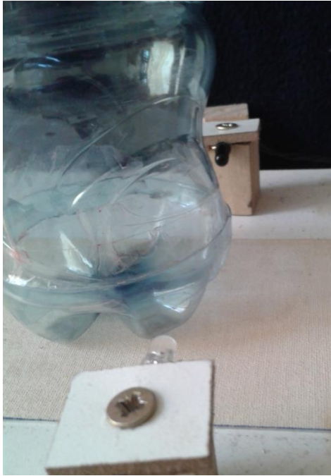
Fig. 4-8: Los sensores detectan la botella.
