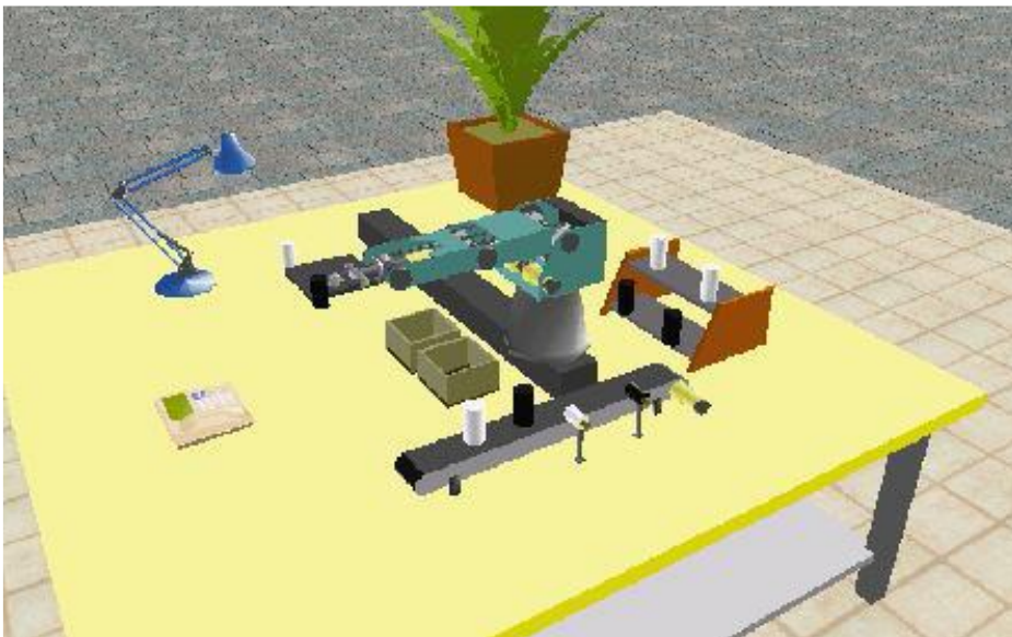
Fig. 1-8: Robot Manipulador Scorbot-ER 4u para el proceso de dos líquidos diferentes [8]
