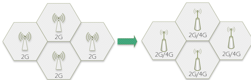
Figura 2. Modernización de 2G a 2G/4G.
