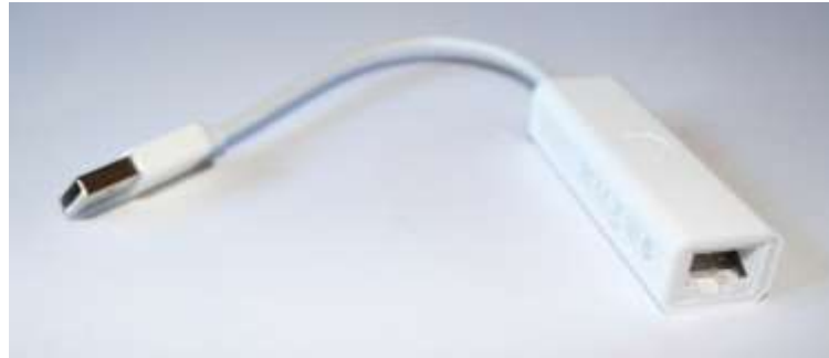
Figura 66. Cable UBS-ETH utilizado para el comisionamiento local para el caso de LTE.
