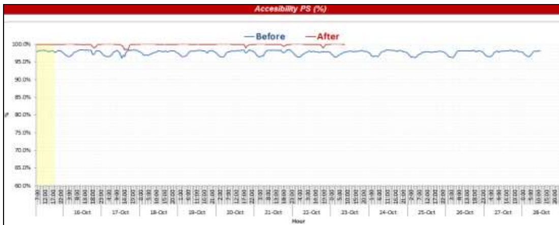
Figura 103. Análisis de KPI de accesibilidad para comunicación por circuitos (CS-GSM, llamadas) y por paquetes (PS-GPRS, datos).
