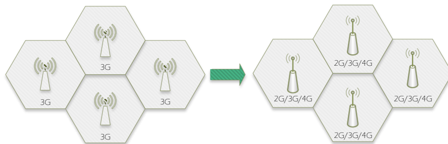
Figura 3. Modernización de 3G a 2G/3G/4G.
