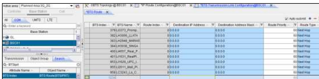
Figura 84. Creación de la ruta estática para la Interface Abis de BTS a BSC.
