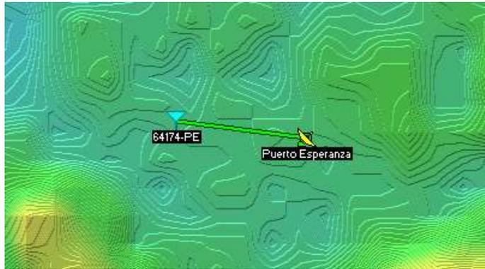
Figura N° 49: “Simulación de línea de vista enlace nodo Puerto Esperanza – IE 64174”
