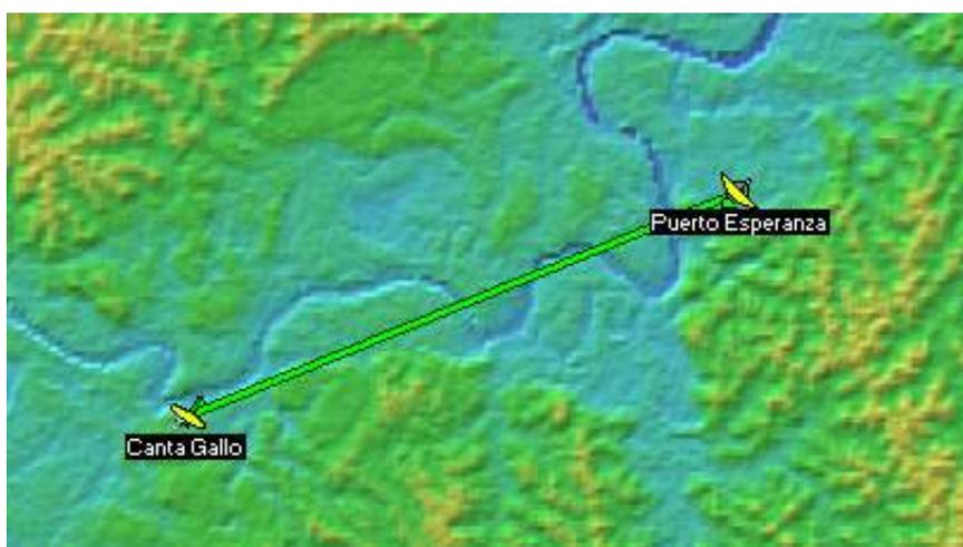
Figura N° 45: “Simulación de línea de vista enlace nodo Puerto Esperanza - Cantagallo”
