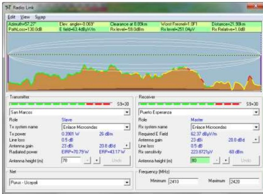
Figura N° 43: “Simulación enlace nodo San Marcos - Puerto Esperanza”
