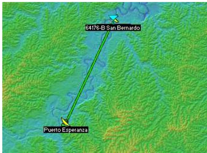
Figura N° 33: “Simulación de línea de vista nodo Puerto Esperanza – San Bernardo”
