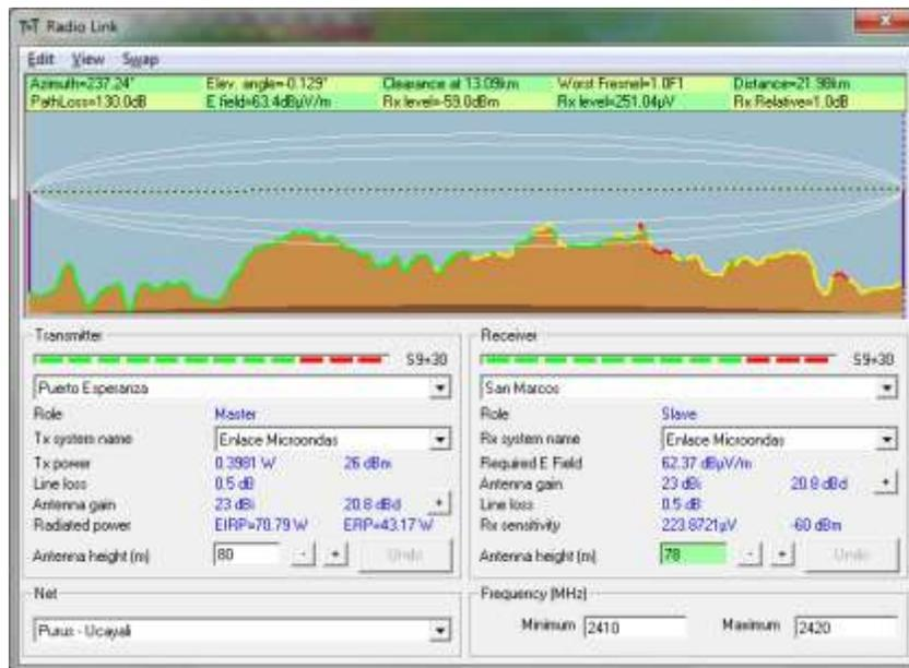
Figura N° 42: “Simulación enlace nodo Puerto Esperanza – San Marcos”
