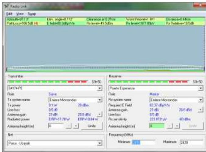
Figura N° 51: “Simulación enlace nodo IE 64174 - Puerto Esperanza”
