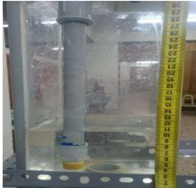
Figura 3.13: Llenado de agua en recipiente a 10 cm.
