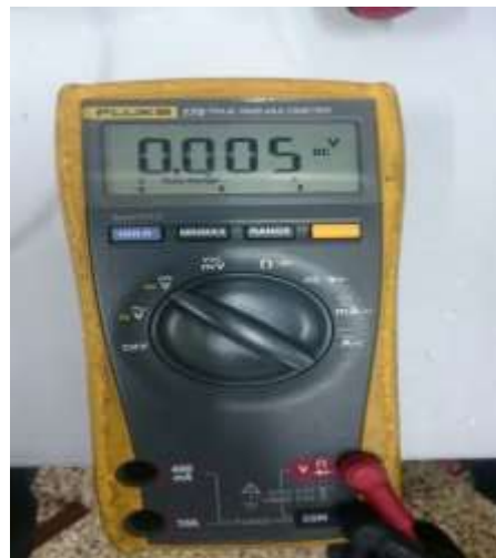
Figura 3.31: Lectura de voltaje a la salida del amplificador y entrada de la válvula, de 0 VDC.
