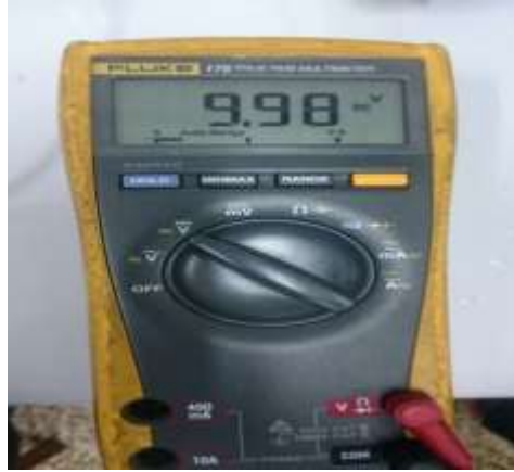
Figura 3.19: Lectura de voltaje a la salida del amplificador y entrada de la válvula, de 10 VDC.
