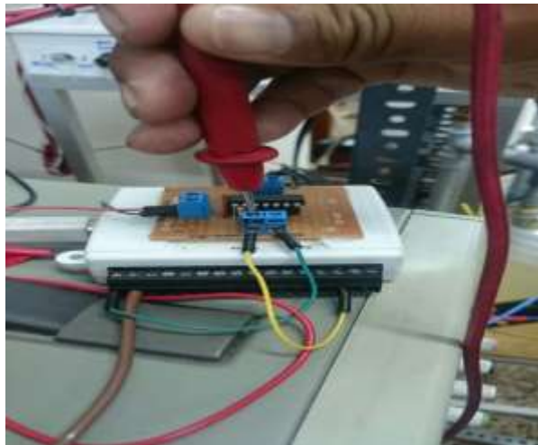
Figura 3.15: Lectura de voltaje a la salida de la DAQ.
