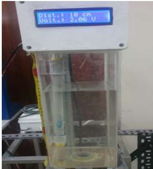
Figura 2.10: Sensor de Nivel y acondicionamiento para el nuevo módulo.
