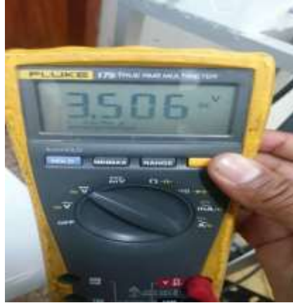
Figura 3.21: Lectura de voltaje a la salida de la DAQ, de 3.5 VDC.
