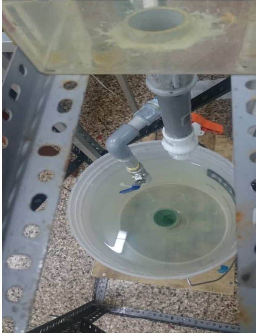
Figura 2.14: Malla filtro a la salida de tanque de alimentación.
