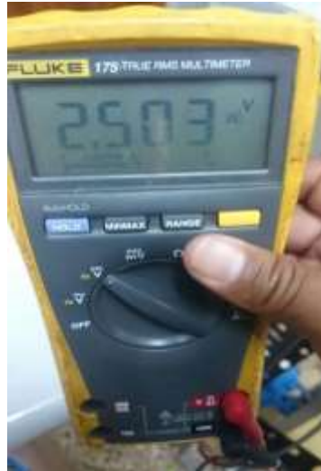
Figura 3.24: Lectura de voltaje a la salida de la DAQ, de 2.5VDC.
