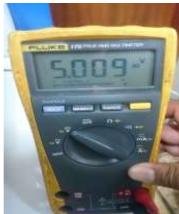
Figura 3.25: Lectura de voltaje a la salida del amplificador y entrada de la válvula, de 5 VDC.
