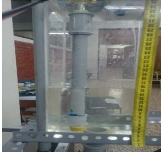
Figura 3.11: Llenado de agua en recipiente a 15 cm.
