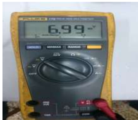
Figura 3.22: Lectura de voltaje a la salida del amplificador y entrada de la válvula, de 7 VDC.
