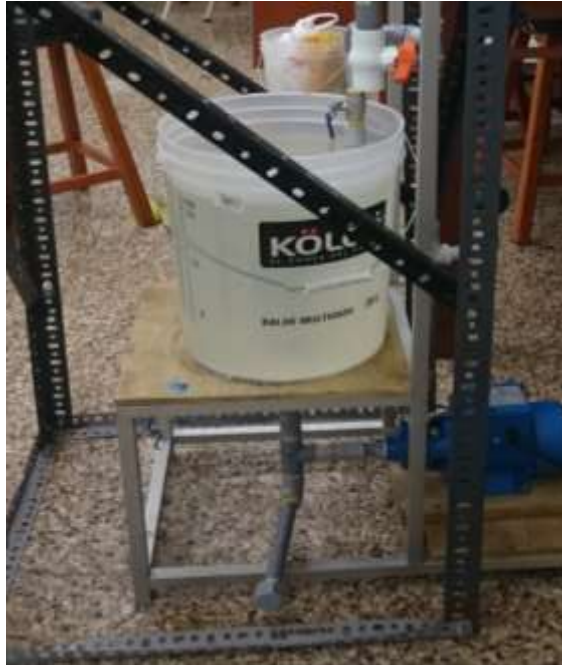
Figura 2.12: Tanque para alimentación en nuevo módulo.
