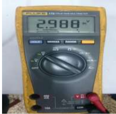
Figura 3.28: Lectura de voltaje a la salida del amplificador y entrada de la válvula, de 3 VDC.
