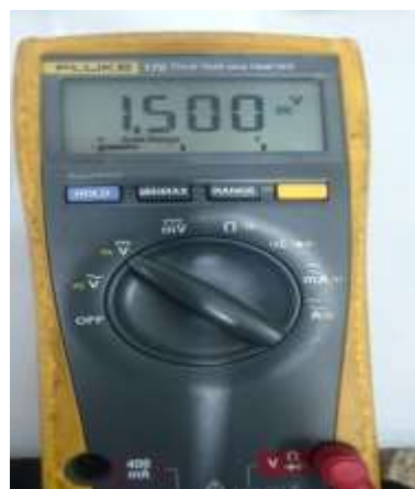
Figura 3.27: Lectura de voltaje a la salida de la DAQ, de 1.5 VDC.
