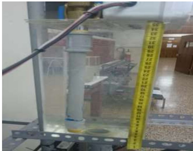
Figura 3.7: Llenado de agua en recipiente a 30.5 cm.
