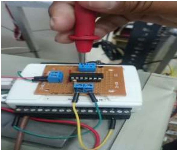
Figura 3.16: Lectura a la salida del amplificador de voltaje y entrada de la válvula.
