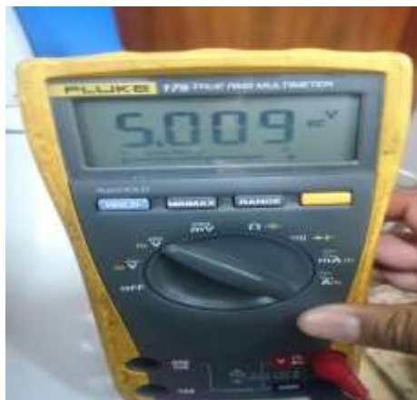
Figura 3.18: Lectura de voltaje a la salida de la DAQ, de 5 VDC.
