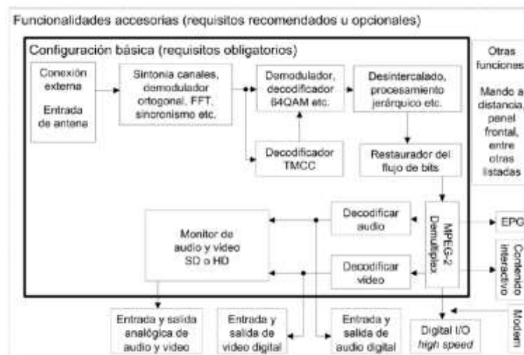
Figura 4.11: Esquema Básico de Recepción.
