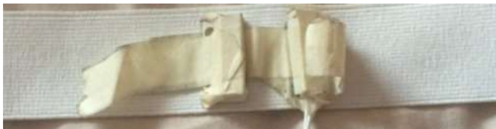
Figura N° 35: Adaptación del sensor magnético en una banda elástica para poder medir el número de respiraciones por minuto (RPM) en infantes.
