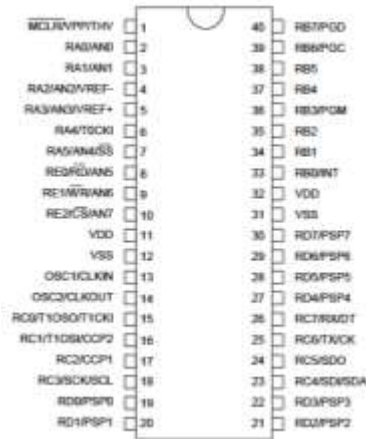
Figura N° 17: Distribución de pines del PIC16F877A.
