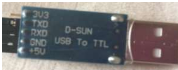
Figura N° 44: Módulo conversor USB a Serial RS232 PL2303.
