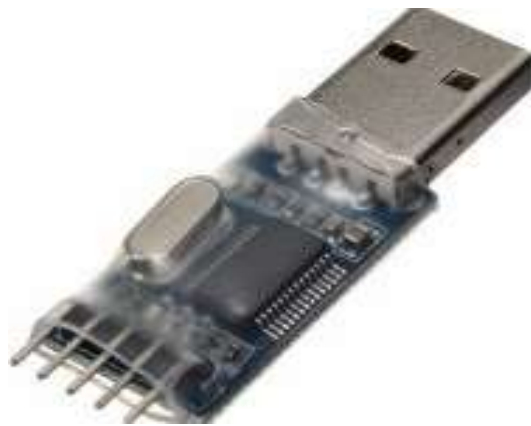
Figura N° 43: módulo conversor USB a Serial RS232 PL2303.
