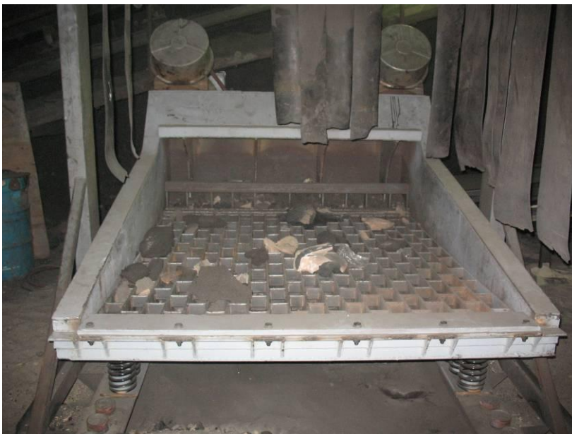
Figura 4.2 Ingreso de arena en bloques a la Zaranda Vibradora
