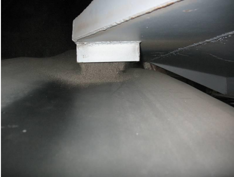
Figura 4.3 Salida de arena en Granos de la Zaranda Vibradora
