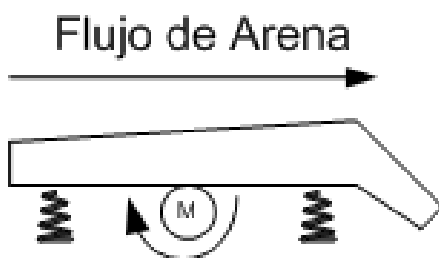
Figura 4.6.2 Diagrama de sentido de Giro de Motor Vibrador y Dirección de la Arena Se debe considerar en el caso de dos motores el movimiento de rotación de estos será inverso uno respecto al otro a diferencia del caso de utilizar un solo motor que el movimiento será en sentido del flujo de arena.
