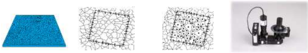
Figura N°5: Fragmentación de un vidrio templado
