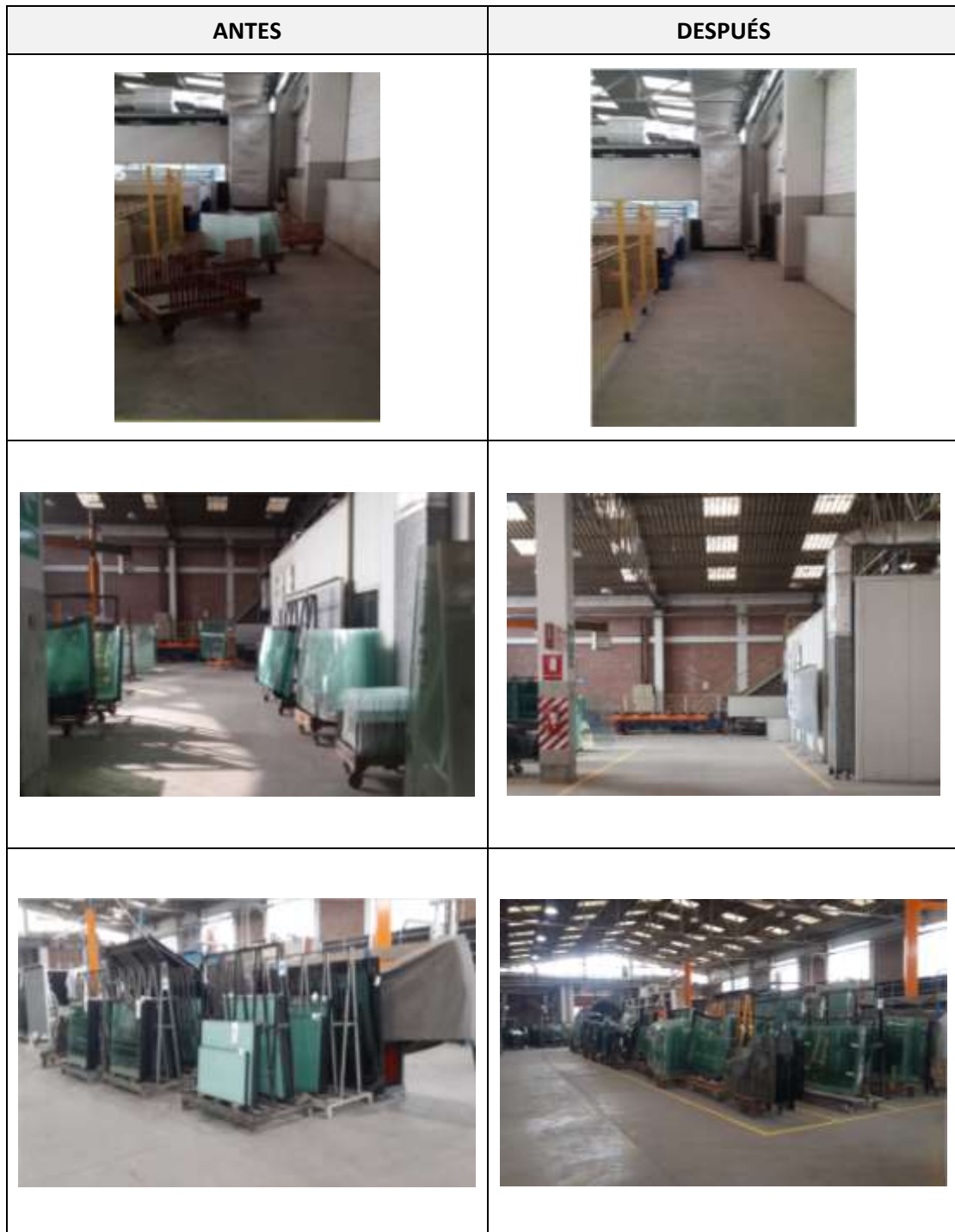
Figura N°22c: Orden y limpieza de pasadizos en el área de laminados (antes y después).
