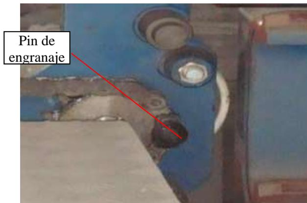
**Figura N° 1.20:** Pin de engranaje centrado
