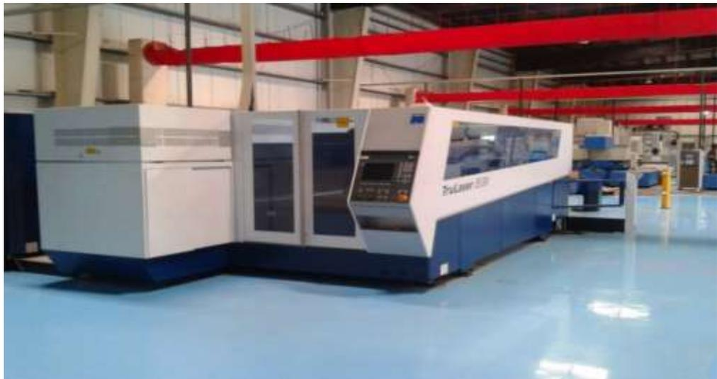
**Figura N° 1.5** Equipo CNC de corte laser
