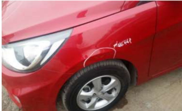
Daño en guardafangos delantero / Fuente: Propia
