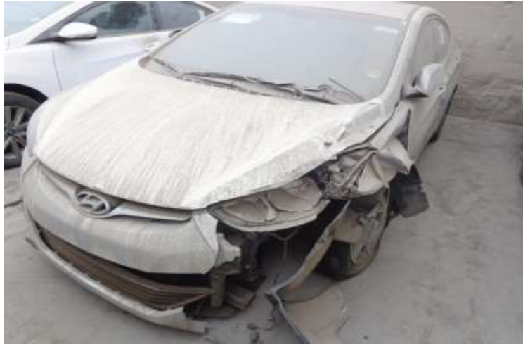
Daño en parachoques y guardafangos delantero / Fuente: Propia
