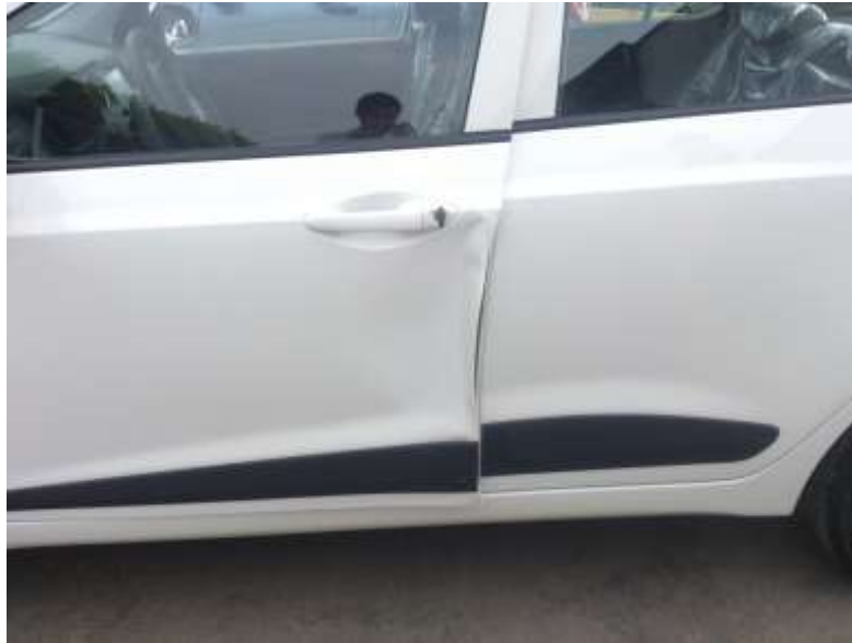
Daño en puerta delantera (copiloto) / Fuente: Propia
