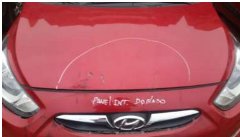
Daño en parte del capot y parachoque delantero / Fuente: Propia
