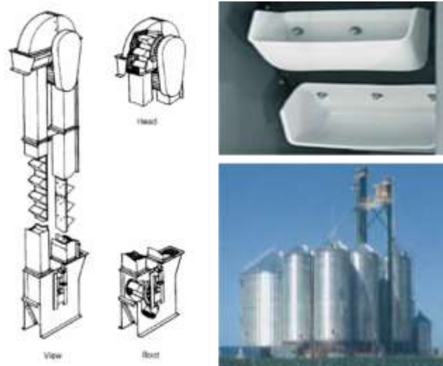
Figura 15. Elevador de cangilones para el llenado de un conjunto de silos Fuente: Coulson (2002)
