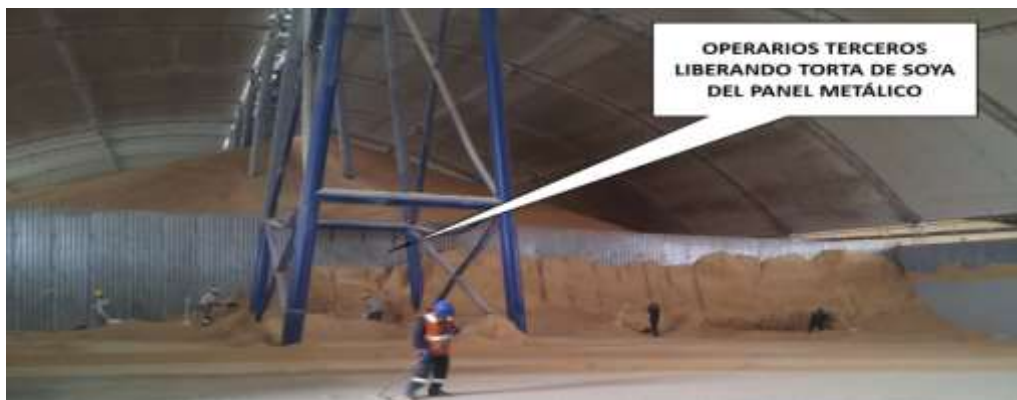
Figura 27. Liberación de paneles en almacén bajo techo. Fuente: Datos de la empresa, Elaboración propia.
