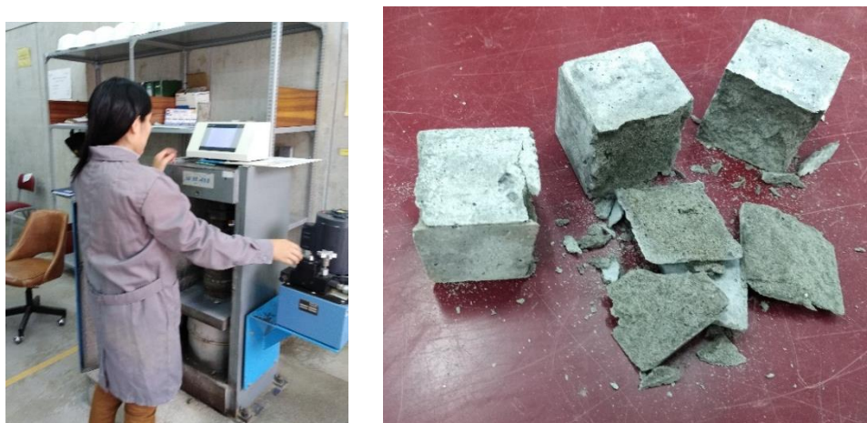
Figura 6. Ensayo de resistencia a la compresión de especímenes de mortero.
