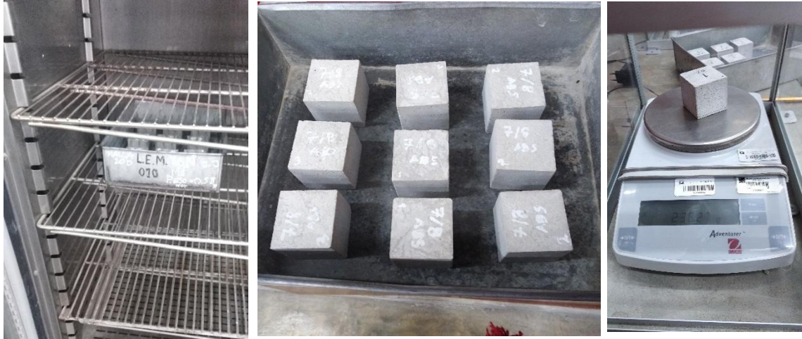
Figura 14. Secado, enfriado y pesado inicial de muestra de mortero para ensayo de absorción
