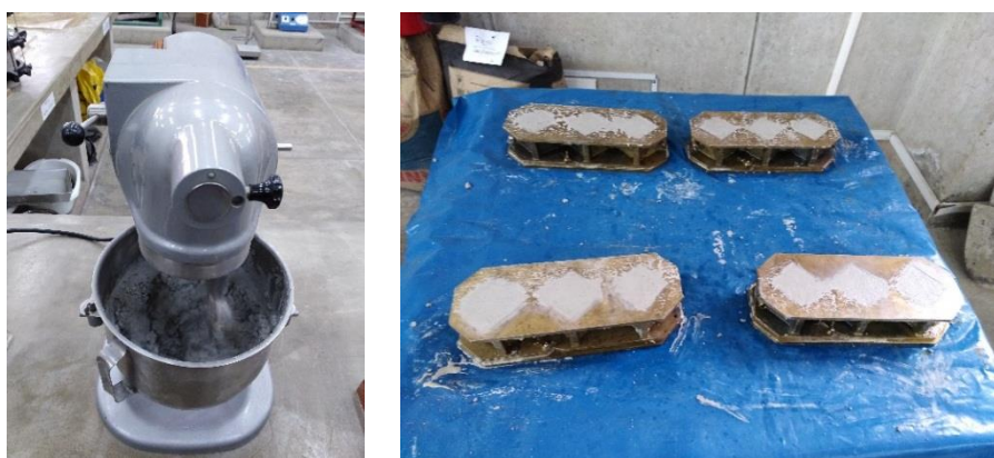
Figura 5. Mezclado y moldeado de especímenes de mortero.
