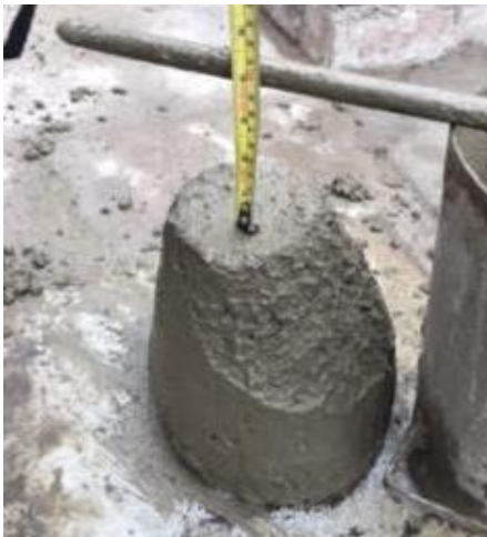
Figura 12: Asentamiento a los 60 minutos Fuente: Elaboración propia
