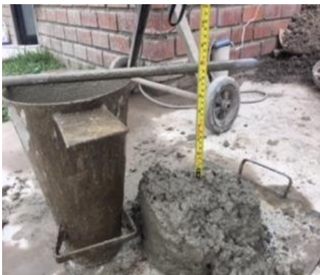
Figura 14: Asentamiento a los 90 minutos Fuente: Elaboración propia
