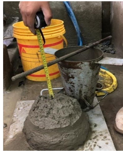
Figura 13: Asentamiento con adición de agua Fuente: Elaboración propia
