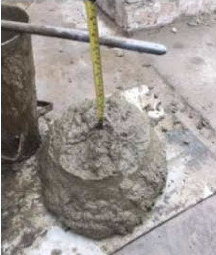
Figura 10: Asentamiento a los 0 minutos Fuente: Elaboración propia
