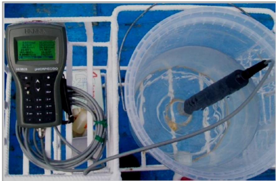
Figura 2. Medición de los parámetros físico químicos con el uso del Multiparámetro Hanna HI9828
