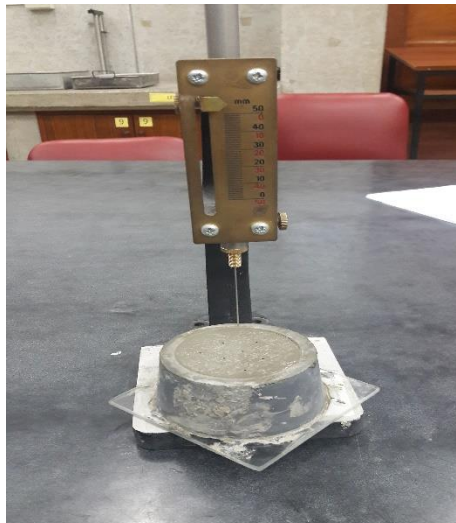
Figura N° 6: Aparato de Vicat Fuente: Elaboración Propia
