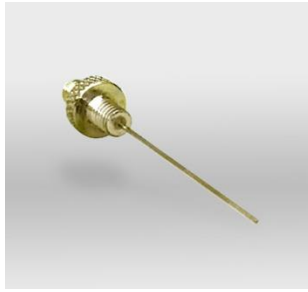
Figura N° 2: Aguja de Vicat Fuente: Elaboración Propia
