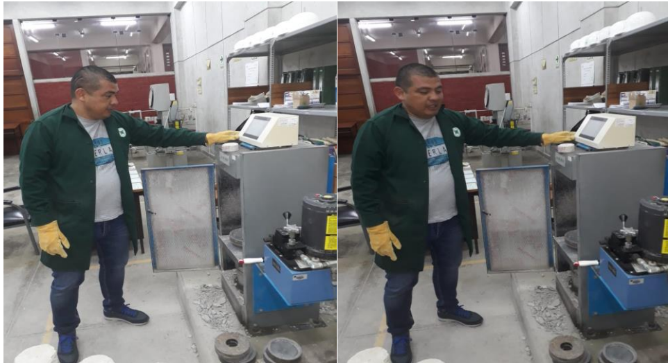
Figura N° 49: Ensayo de Resistencia a la Compresión de cubos de mortero Fuente: Elaboración Propia
