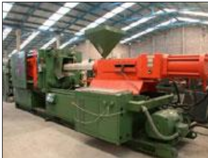
Figura N° 8: Maquina Inyectora Automática I
