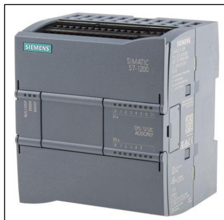
Figura N°46: PLC Siemens S71200
