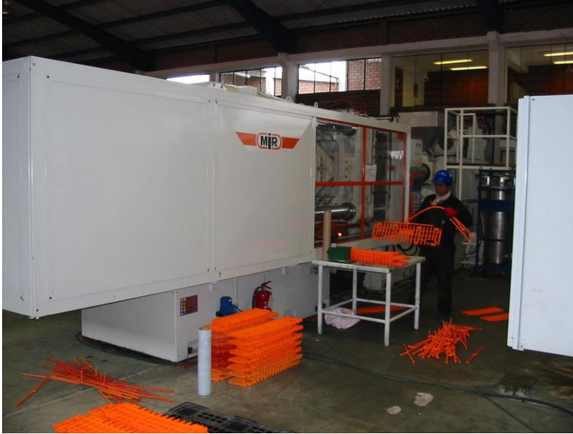
Figura N° 3: MAQUINA INYECTORA 830 - A
