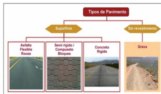
Figura N° 13 Clasificación de tipos de pavimentos basados en materiales (Sudáfrica)
