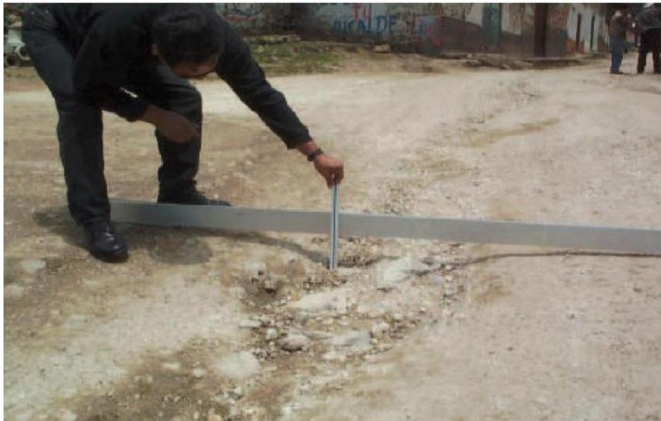
Figura N° 6 Gravedad 3: Profundidad  $\geq 10$  cm
