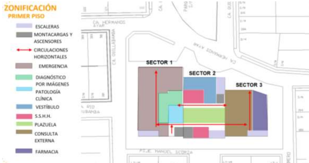
Figura 131. Zonificación del primer piso.
