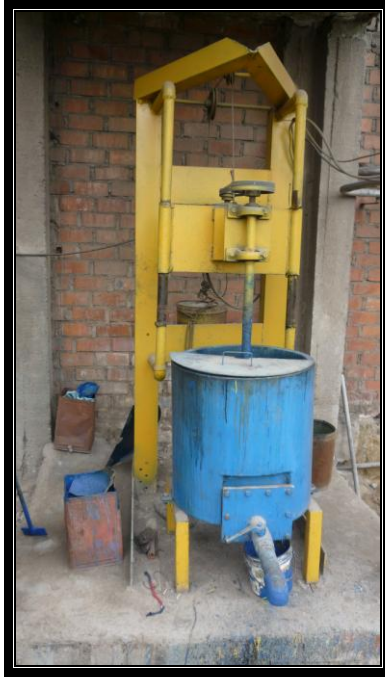
Maquina de molienda para la fabricación de pintura de alto rendimiento
