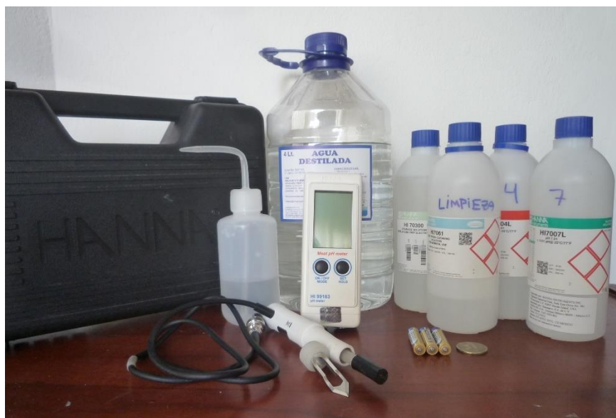
FIGURA 8.- Soluciones pH 7.00 y 4.00, agua destilada, solución de mantenimiento de electrodo, solución limpiadora de electrodos, electrodo y pH-metro.
