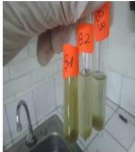
Figura N°5 Centrifugar 2 min por 2000 rpm
