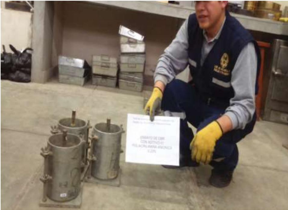
Figura 14: Curado a temperatura ambiente de los moldes de CBR por 7 días. Luego se sumergió en agua por 4 días.
