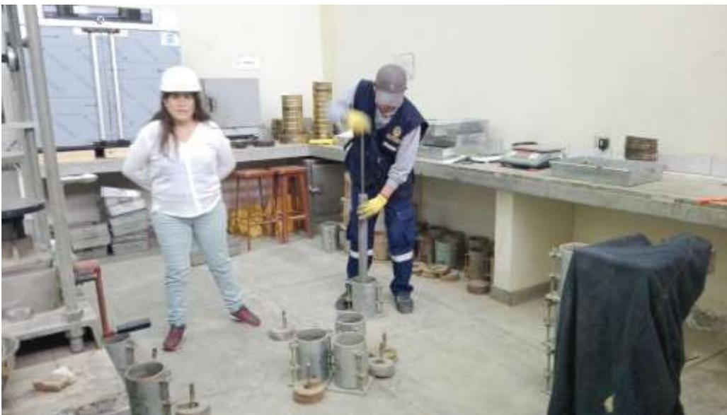
Figura 13: Apisonamiento en 5 capas de la muestra combinada
