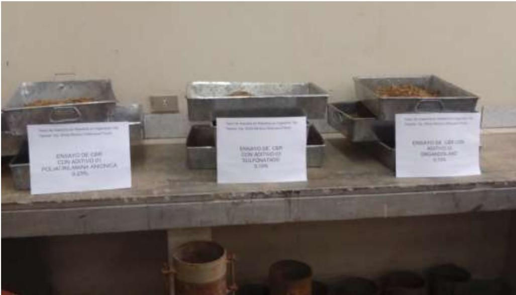
Figura 12: Muestras combinadas con los 3 tipos de estabilizadores químicos
