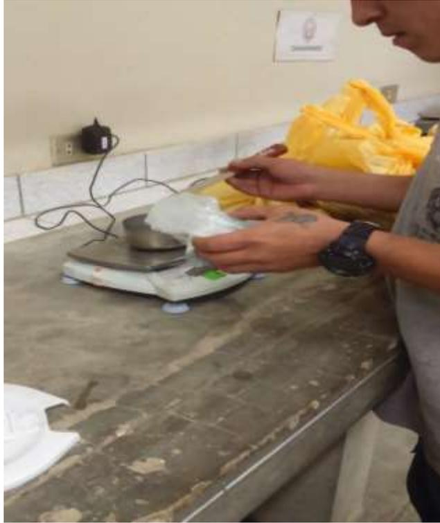
Figura 10: Se observa la medición y pesaje del estabilizador químico poliacrilamida aniónica
