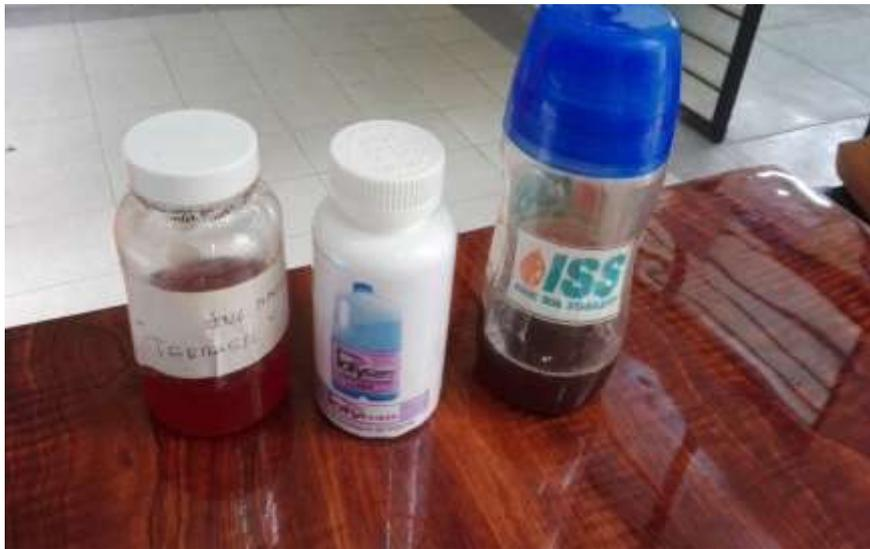
*Figura 7:* Se muestra los 03 estabilizadores estudiados, el primero un derivado organosilano, el segundo el polímero y el tercero un derivado sulfonatado.
