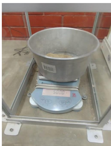
Figura 10: Muestra para ensayo de contenido de humedad del agregado fino.
