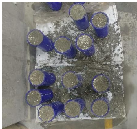
Figura 14: muestreo de probetas de concreto liviano.
