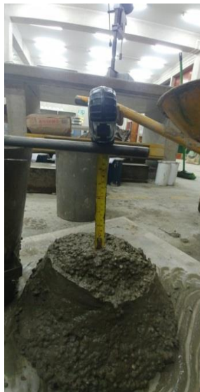
Figura 15: asentamiento el concreto mediante el ensayo de cono de Abrams.
