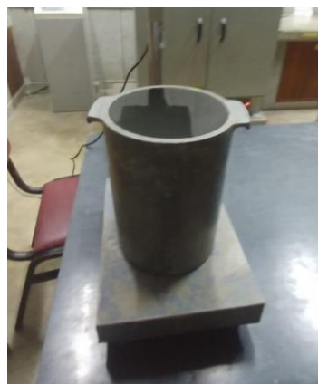
Figura 16: Calibración del molde de peso unitario.
