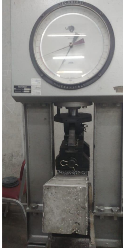
Figura 19: Ensayo de resistencia a la flexión.
