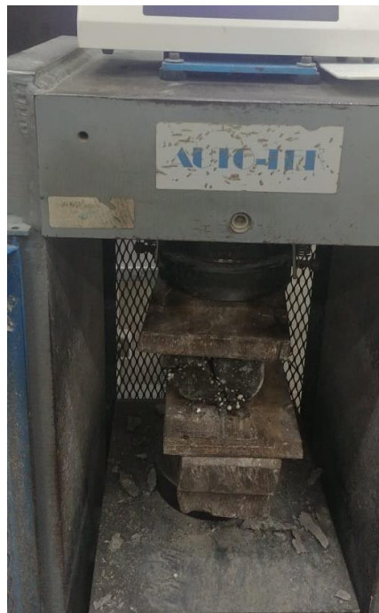
Figura 18: ensayo de tracción por compresión diametral.
