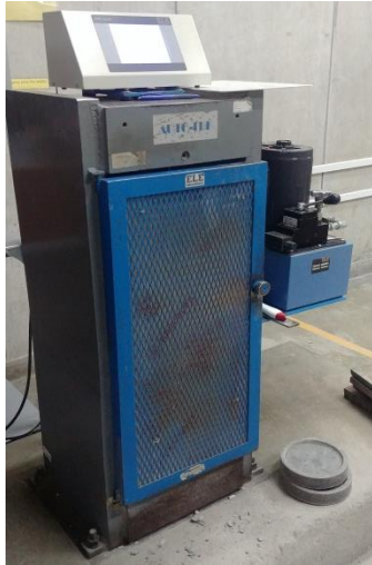
Figura 7: Maquina de compresión axial electro-hidráulica digital
