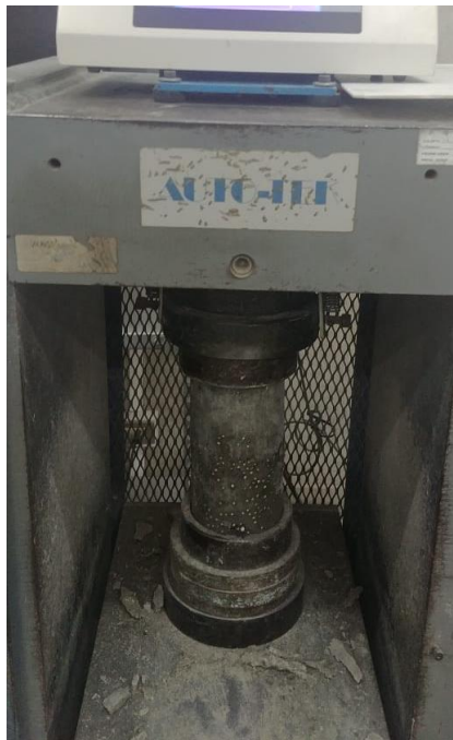
Figura 17: Ensayo de resistencia a la compresión.
