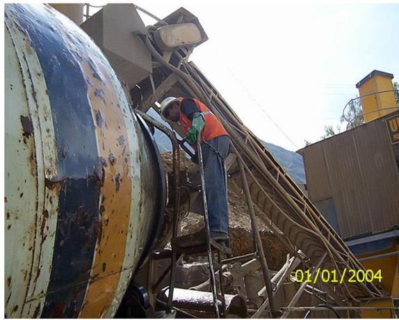
**Paso 9: Se inspecciona la uniformidad de la mezcla.**
