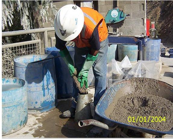
**Paso 11: Se inicia con el ensayo de slump colocando el concreto en el cono.**
