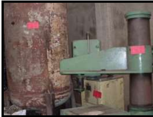
Figura 4.26. Colocación de tarjetas rojas a materiales a ser eliminados y transferidos Fuente: Oficina de Inventarios – Shougang Hierro Perú.
