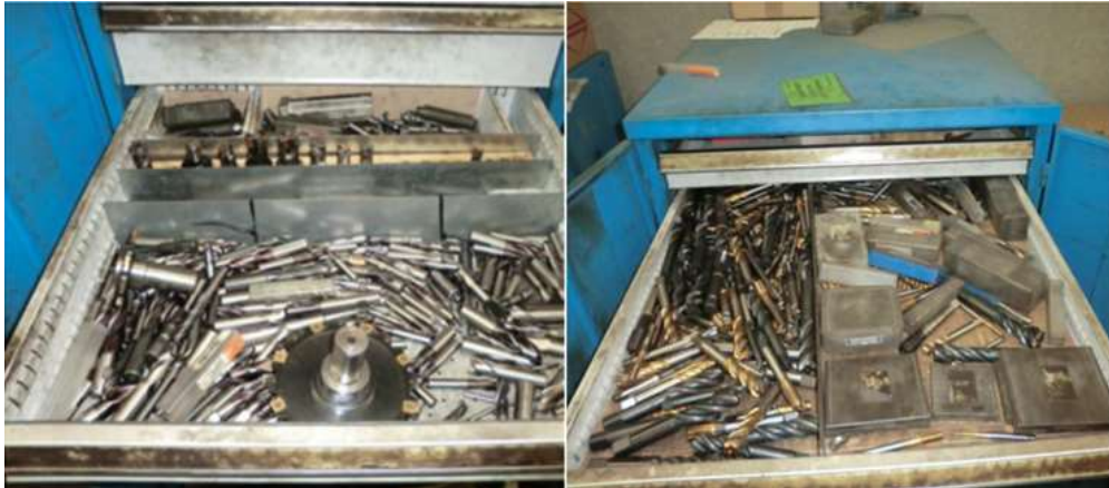
Figura 4.22. Áreas de locación de ítems antes de la implementación de las 5S's. Fuente: Oficina de Inventarios – Shougang Hierro Perú.
