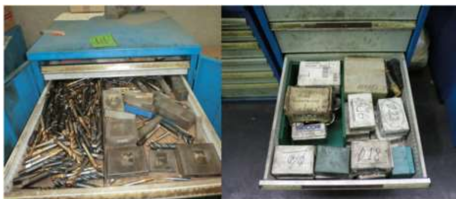
Figura 4.32. Agrupación y rotulado de los ítems antes y después de la implementación. Fuente: Oficina de inventarios – Shougang Hierro Perú.
