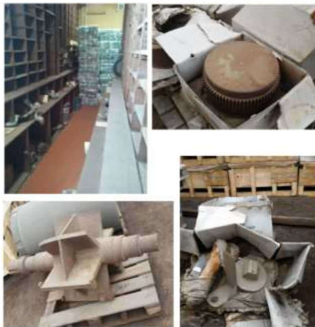
Figura 4.16. Deficiencias en el almacenamiento de los ítems.
