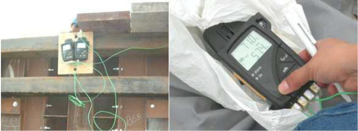
IMAGEN 3.7. Lectores de Temperatura, a 36 horas se detectaron las Máximas temperaturas de 70°C al centro, y 57.4 lateralmente.
