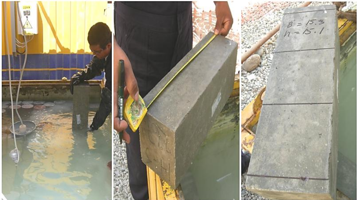
IMAGEN 3.22, Habilitación de la Vigas para el Ensayo a Flexión.
