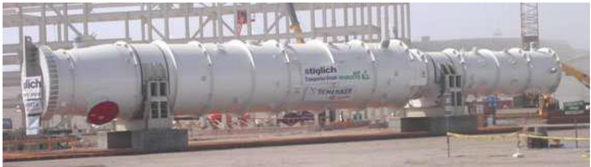
IMAGEN 1.3. Equipo Intercambiador de Calor (longitud: 43 metros, ancho mayo: 5 metros)
