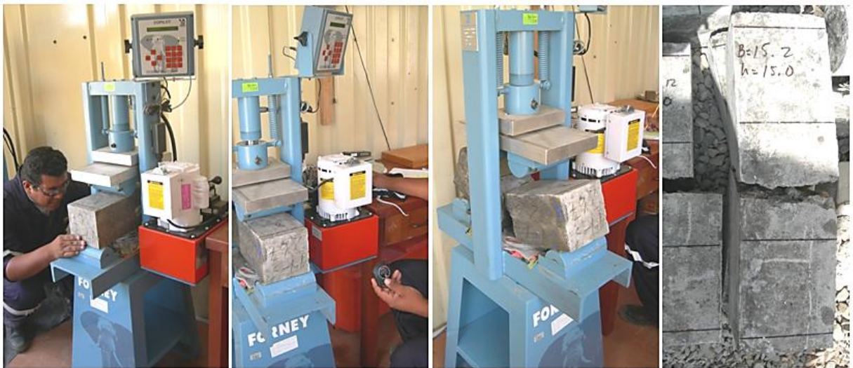
IMAGEN 3.24. Ensayo a Flexión de una Viga.
